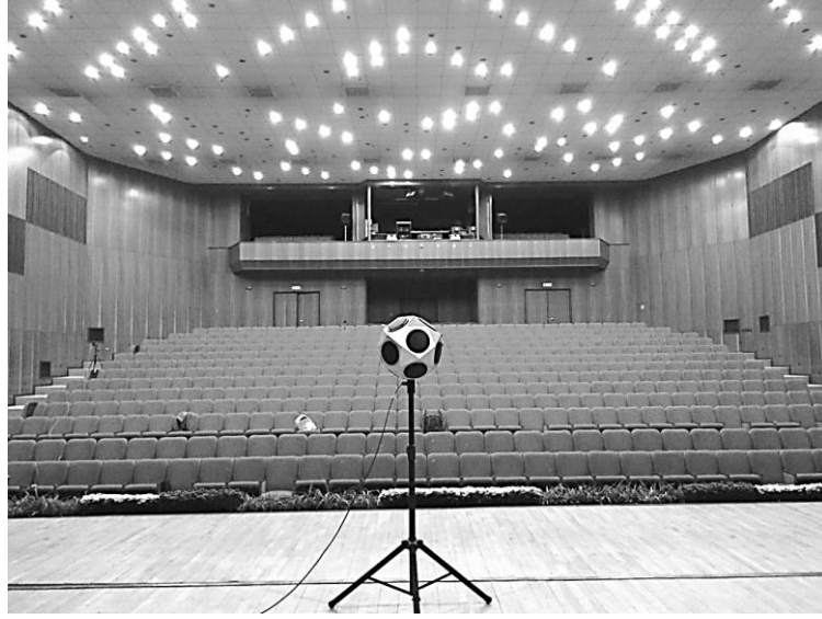
Şekil 5.3. Ölçüm sırasında hoparlörün konumu
