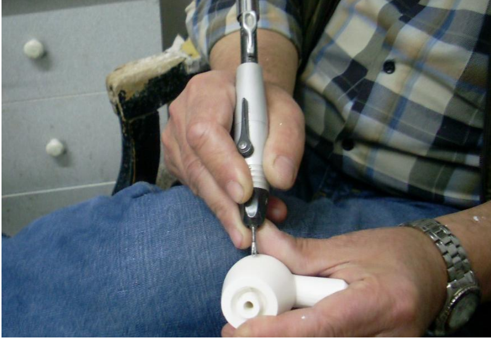
Şekil 44 : Motiflerin freze uçlarıyla işlenmesi
