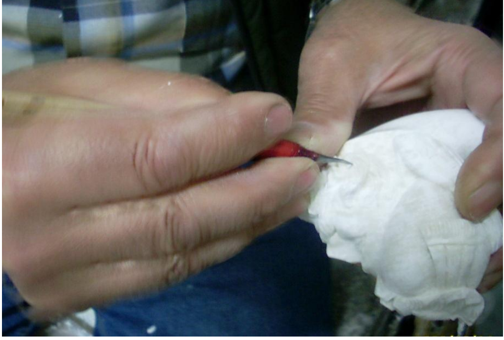
Şekil 42 : Lületaş üzerinde ürünün ana hatlarının belirlenmesi
