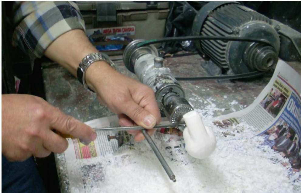
Şekil 45 : Pıponun tütün konulacak kısmın tornadan geçirilmesi
