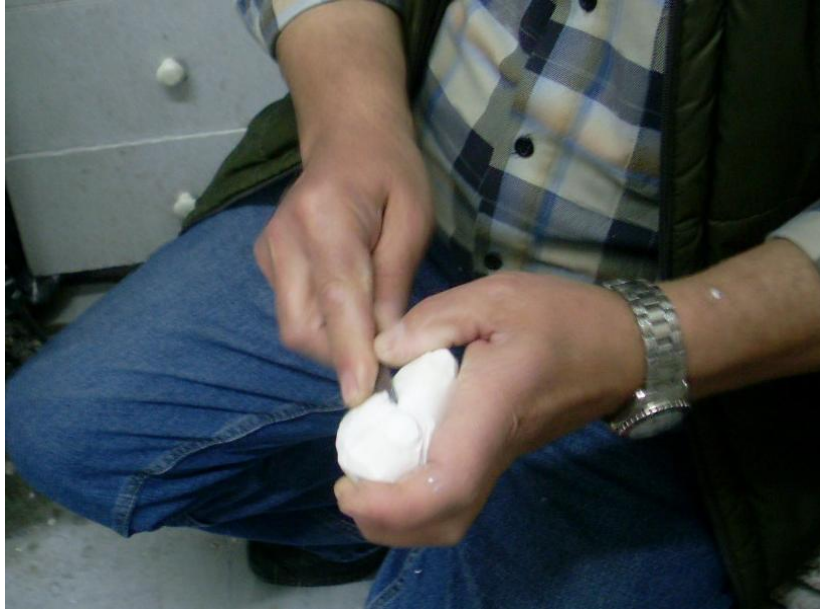
Şekil 41: Lületaşının yontularak şekil verilmesi
