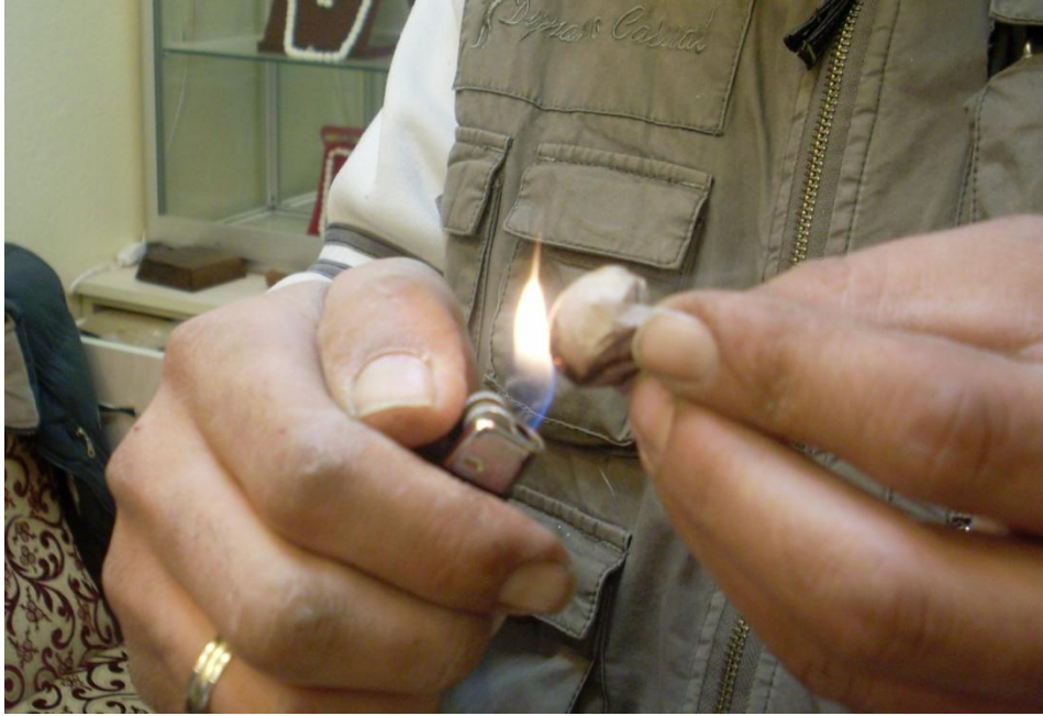
Şekil 34 : Ebru kağıdına sarılı ürünün yakılması
