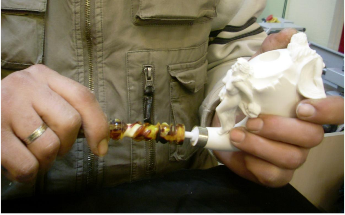
Şekil :49 : Pipo ucunun polyester uçla birleştirilmesi
