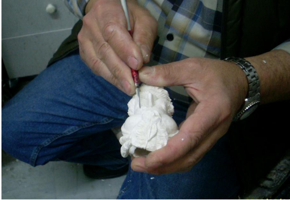
Şekil 43 : İşleme bıçağı ile piponun baş kısmının yüz hatlarının belirginleştirilmesi
