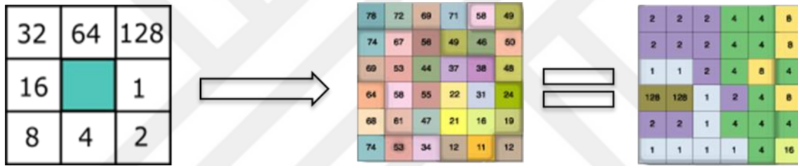
Şekil 52: D8 Metoduna Göre Akış Yönler ve Kodları
