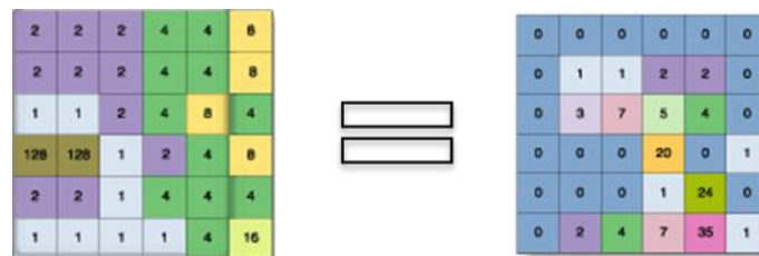
Şekil 53: Doğal Akış Yönü ve Doğal Akımın Belirlenmesine Örnek
