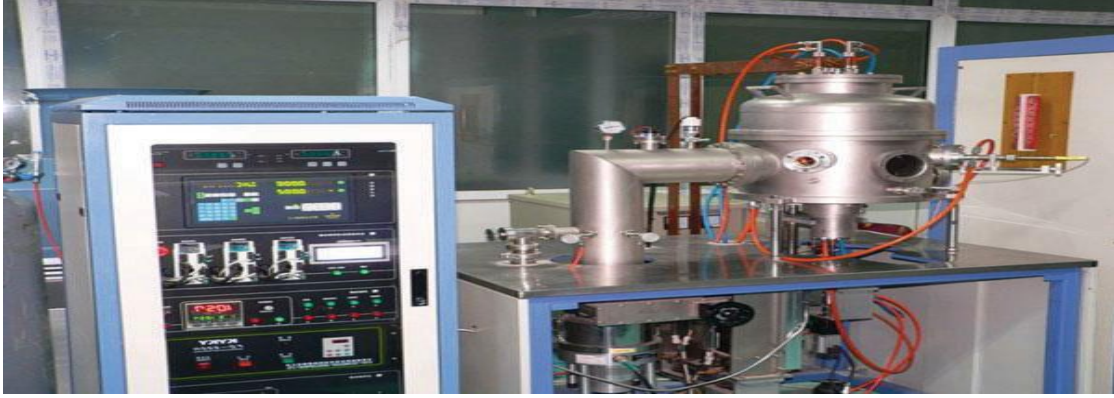
Şekil 1.20 Bridgman katılaşma ekipmanının gösterimi
