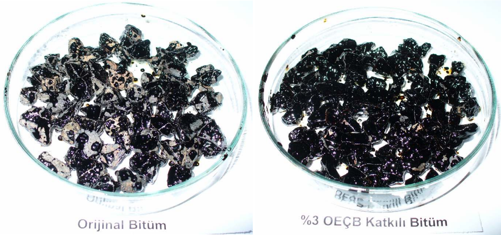
Resim 21.4. Orijinal ve OEÇB katkıli bitümlerin Nicholson soyulma test sonuçları
