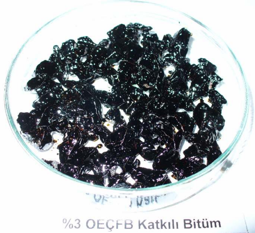
Resim 21.6. Orijinal ve OEÇFB katkıli bitümlerin Nicholson soyulma test sonuçları
