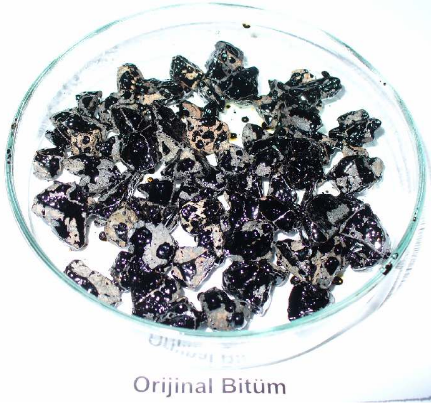
Resim 21.6. Orijinal ve OEÇFB katkıli bitümlerin Nicholson soyulma test sonuçları
