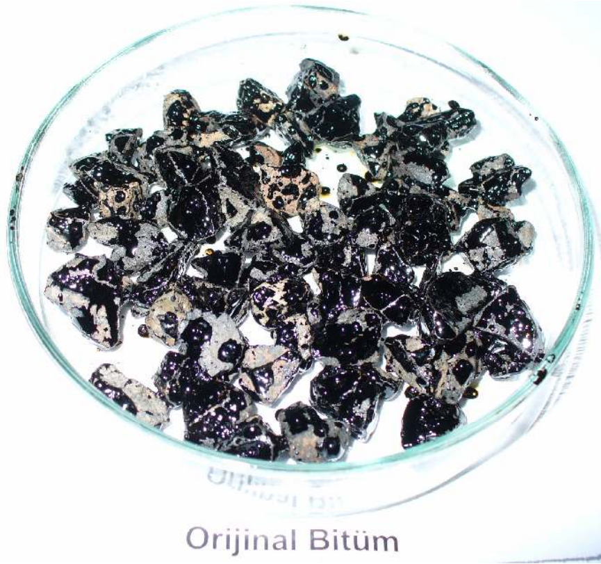
Resim 21.8. Orijinal ve DEGPB katkılı bitümlerin Nicholson soyulma test sonuçları
