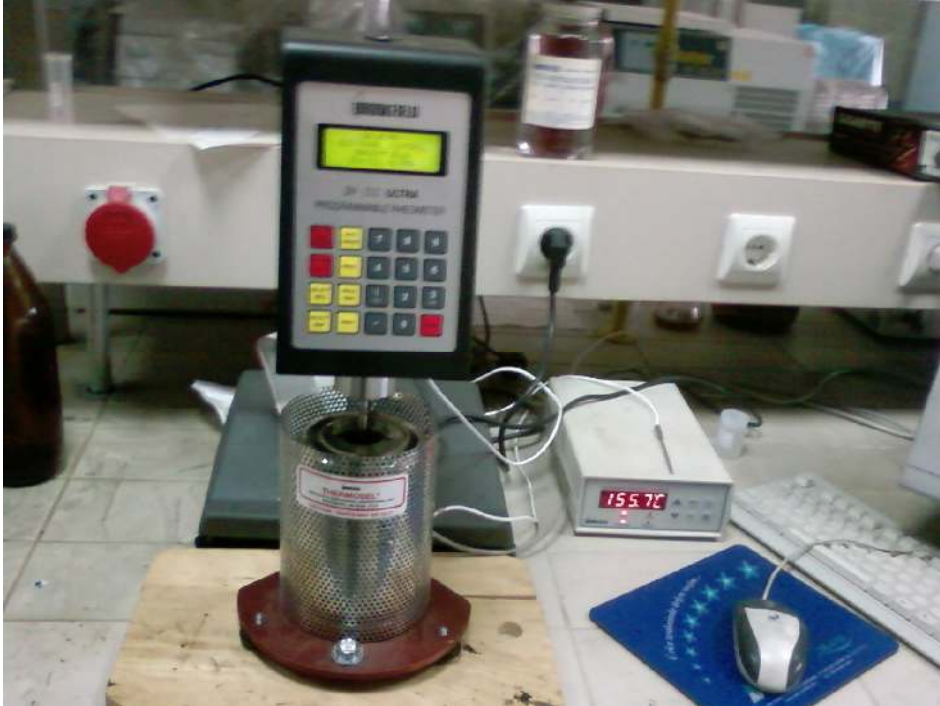
Resim 2.2. Brookfield DV III Ultra Marka programlanabilir viskozimetre
