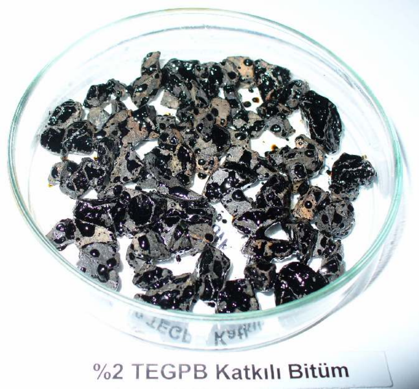
Resim 21.9. Orijinal ve TEGPB katkıli bitümlerin Nicholson soyulma test sonuçları
