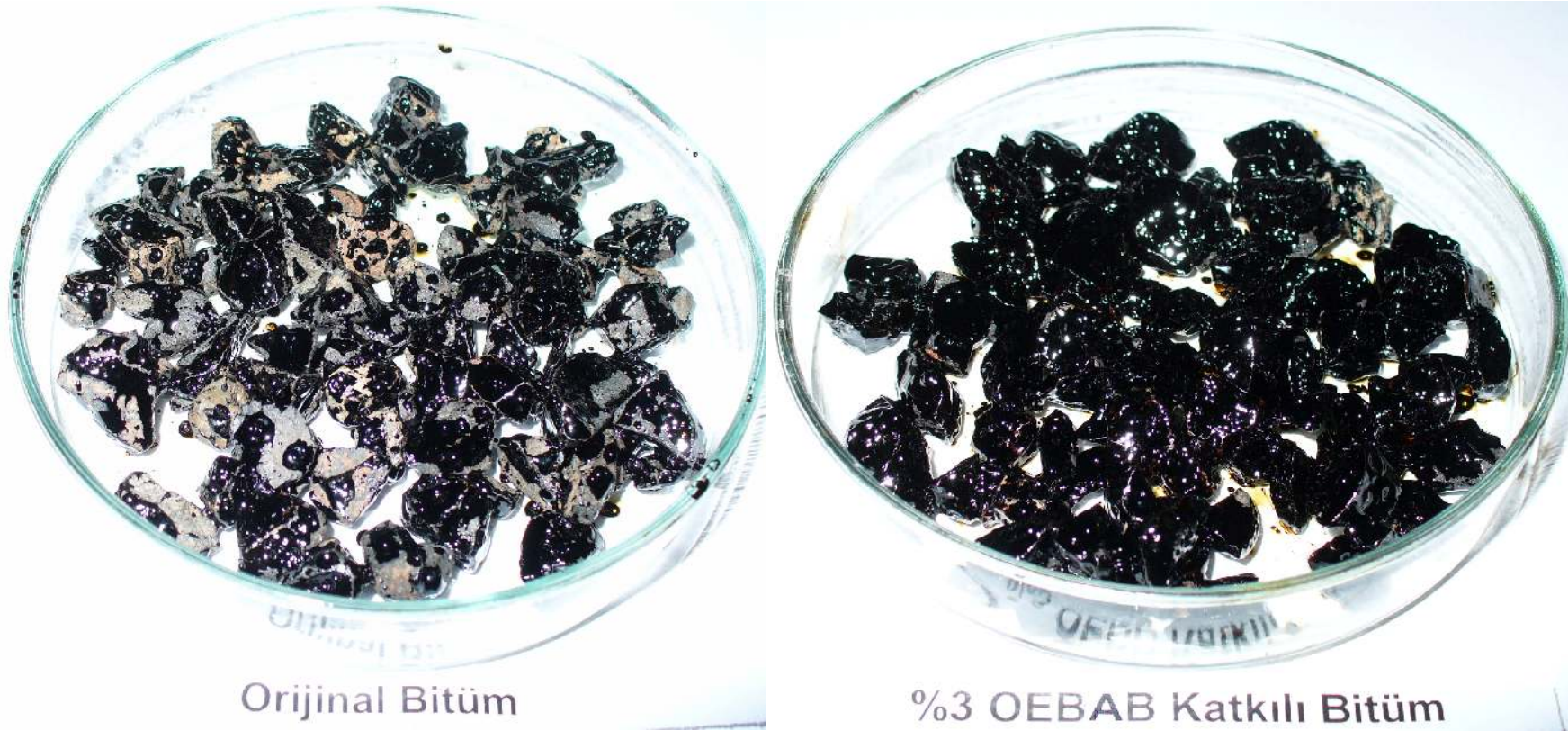
Resim 21.2. Orijinal ve OEBAB katkılı bitümlerin Nicholson soyulma test sonuçları
