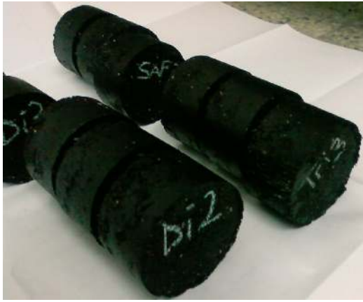
Resim 5.1. Marshall briketlerine ait örnekler
