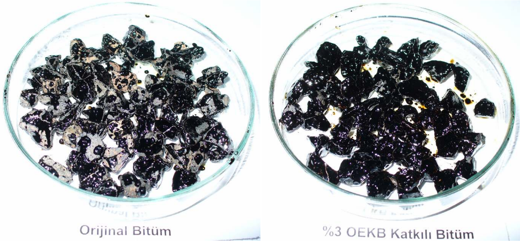
Resim 21.5. Orijinal ve OEKB katkıli bitümlerin Nicholson soyulma test sonuçları
