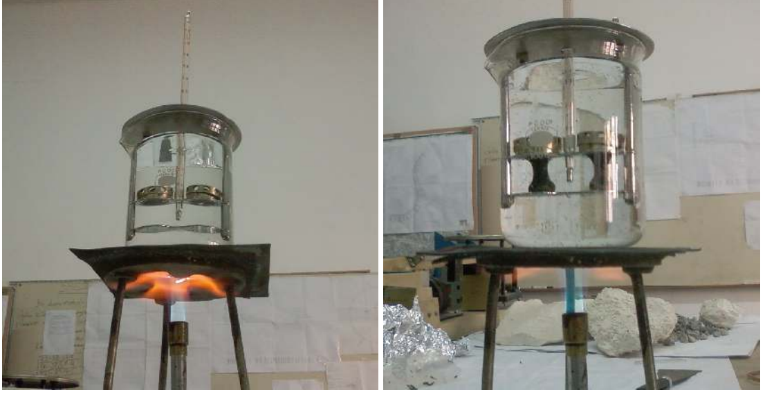
Resim 6.1. Yumuşama noktası ölçümü
