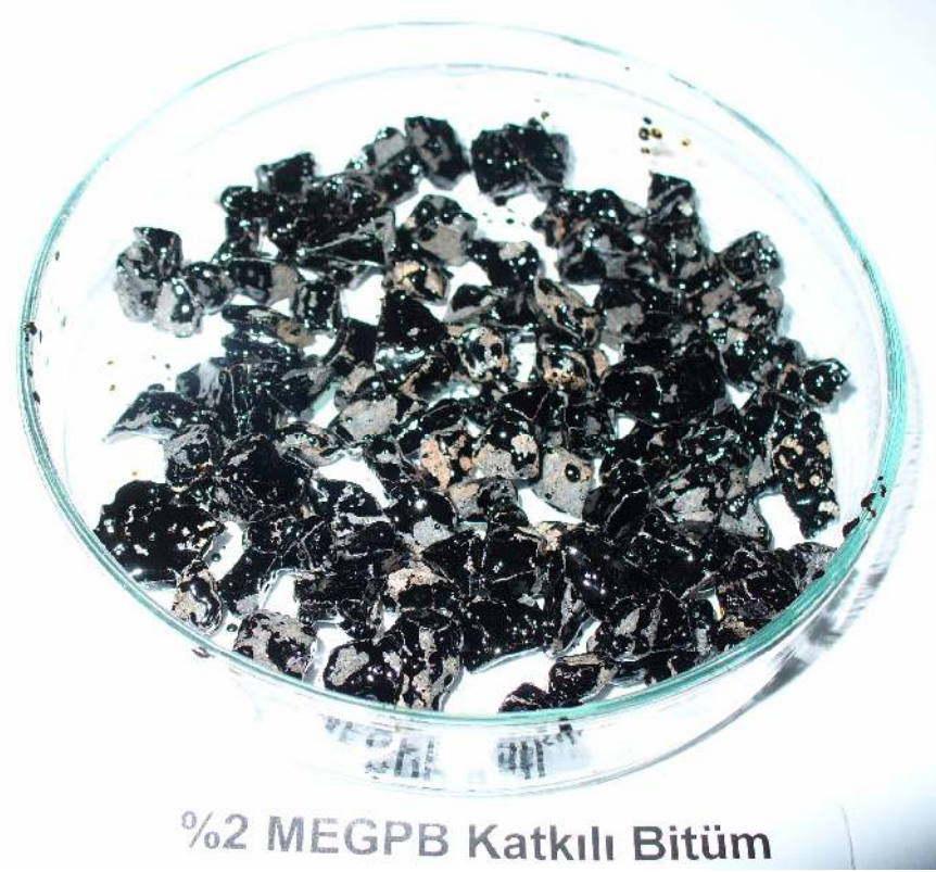
Resim 21.7. Orijinal ve MEGPB katkıli bitümlerin Nicholson soyulma test sonuçları
