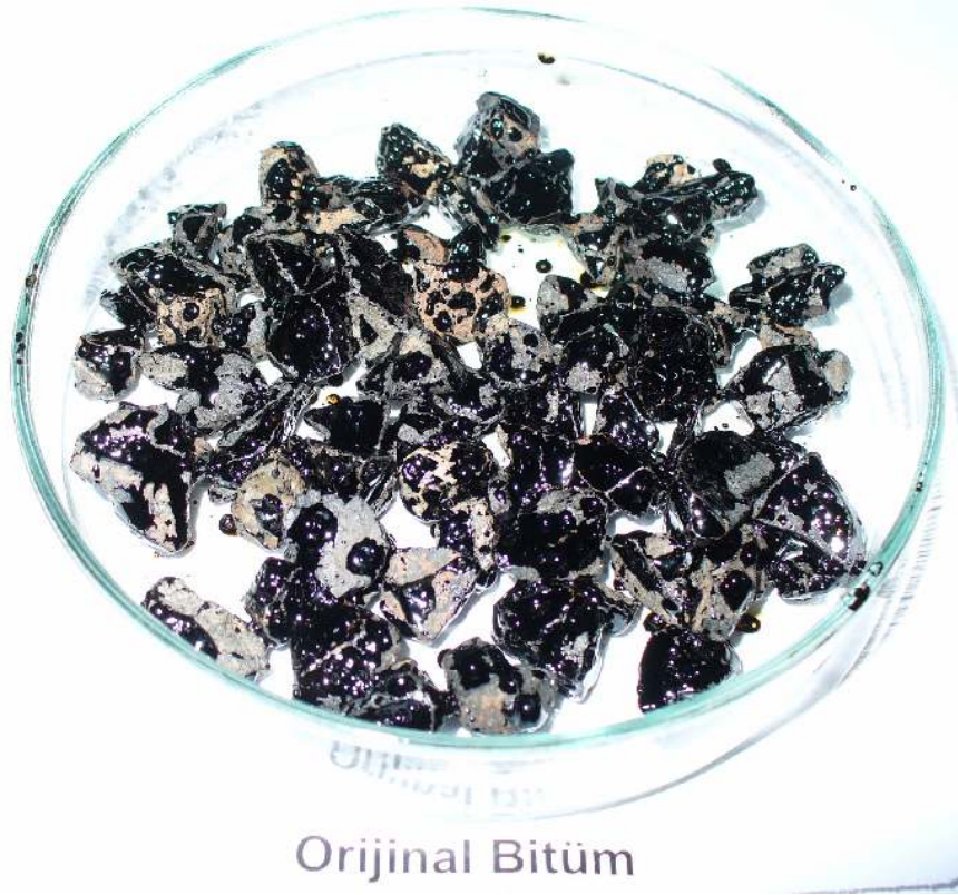
Resim 21.9. Orijinal ve TEGPB katkıli bitümlerin Nicholson soyulma test sonuçları
