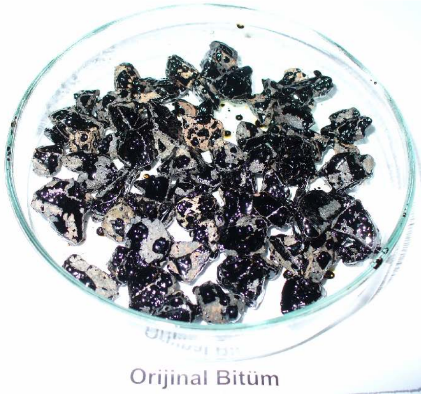
Resim 21.7. Orijinal ve MEGPB katkıli bitümlerin Nicholson soyulma test sonuçları
