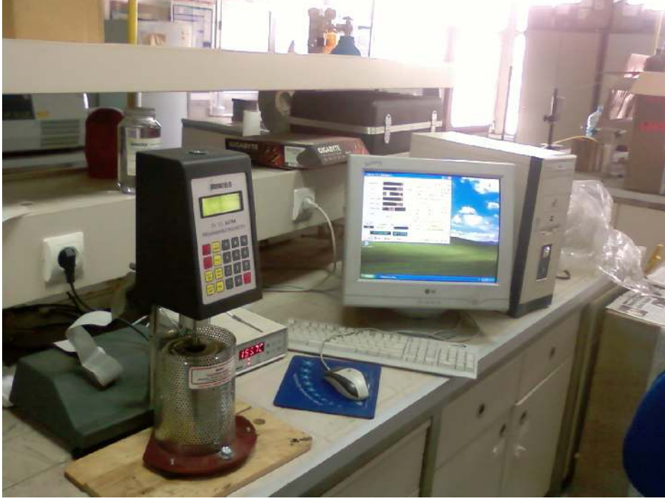
Resim 2.1. Brookfield DV III Ultra Marka programlanabilir viskozimetre
