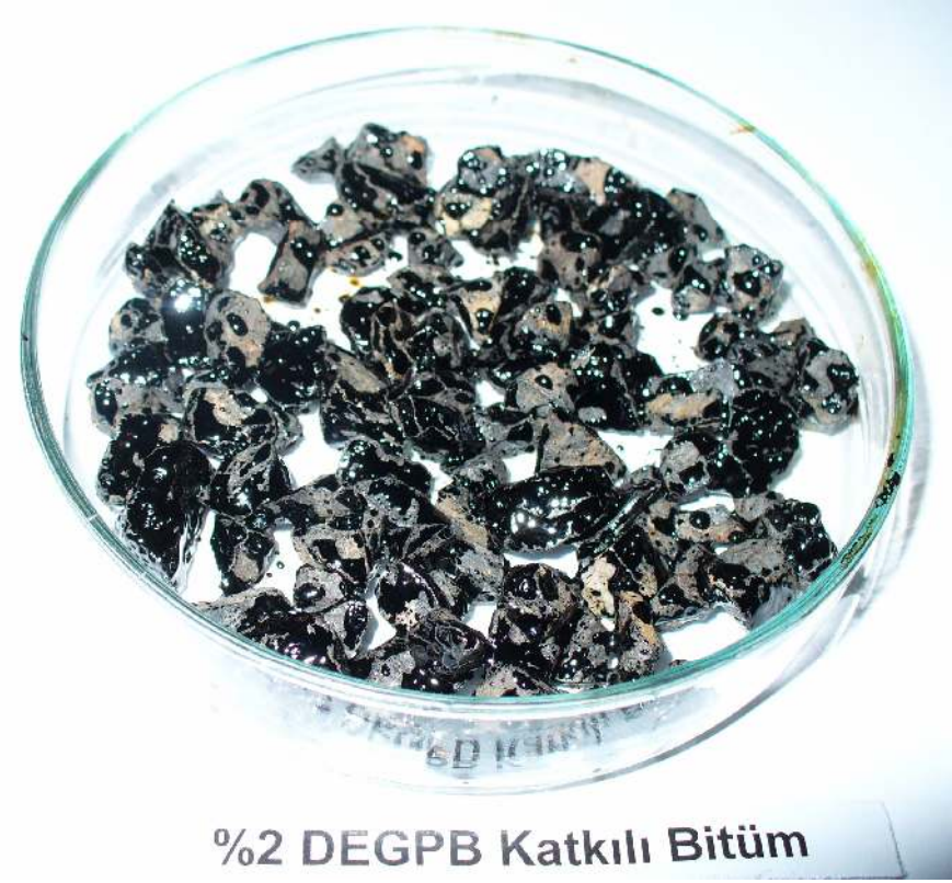
Resim 21.8. Orijinal ve DEGPB katkılı bitümlerin Nicholson soyulma test sonuçları
