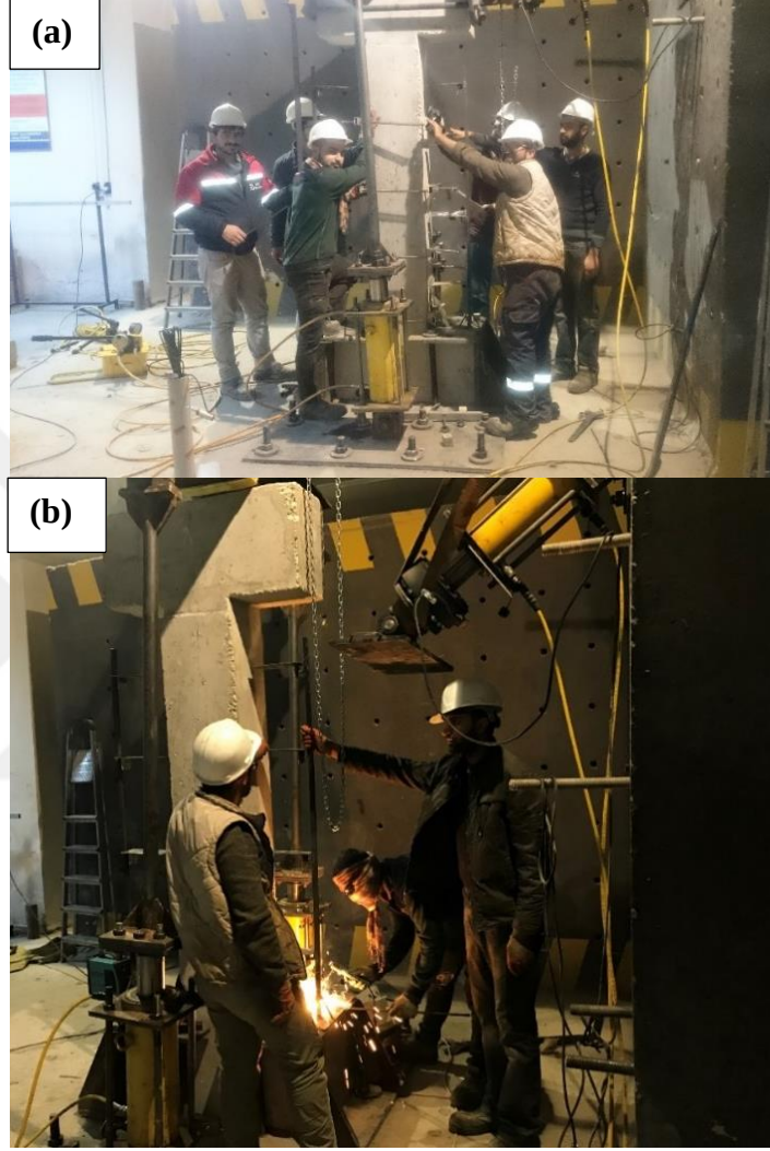
Şekil 3.26. Deney düzenegi kurumu: (a) Ölçüm düzeneklerin kurulması, (b) Deney düzenegin kaynak işleri.
