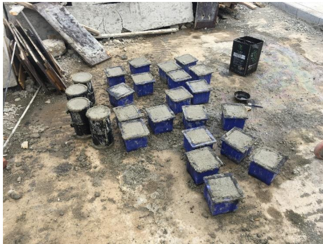
Şekil 3.11. Küp ve silindir numune alımı.
