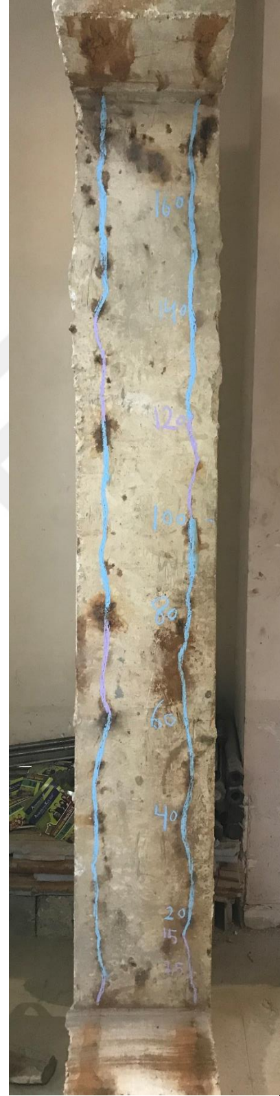
Şekil 3.24. C24 betonarme kolonun çatlak haritası.
