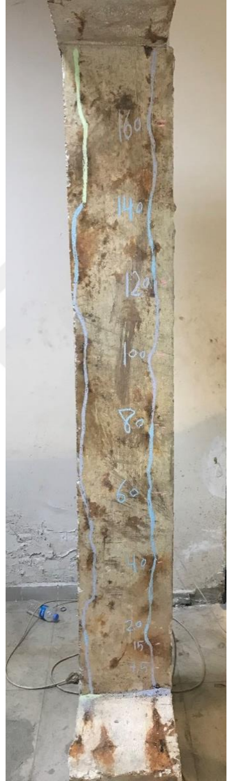
Şekil 3.22. C19 betonarme kolonun çatlak haritası.
