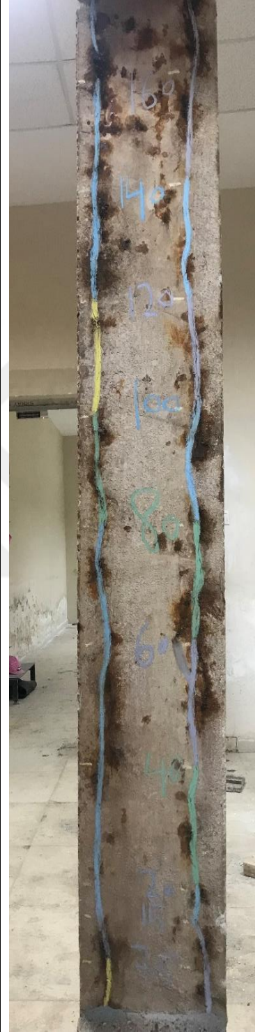
Şekil 3.23. C20 betonarme kolonun çatlak haritası.
