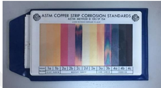
Şekil 2.34 TS 2741 EN ISO 2160 referans korozyon şeritlerinin derecelendirilmesi
