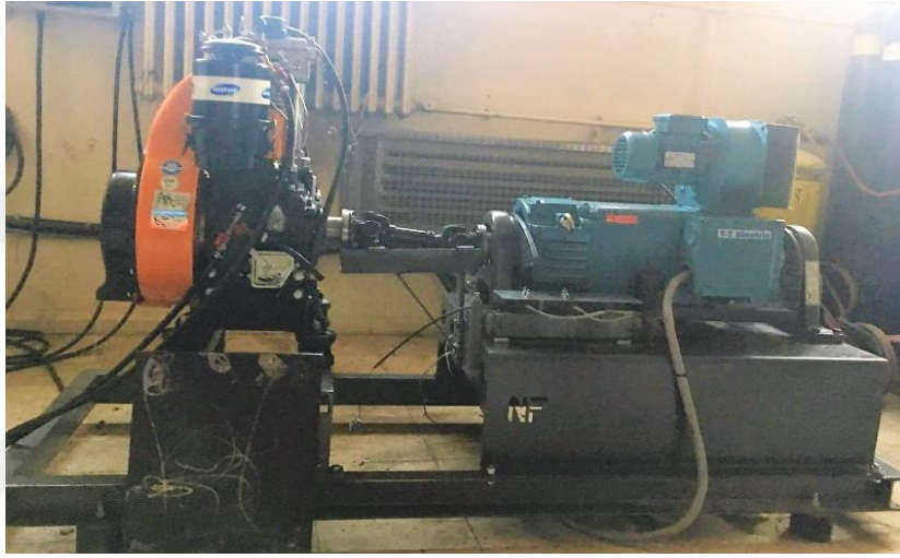
Şekil 2.37 Deney motoru ve dinanometre
