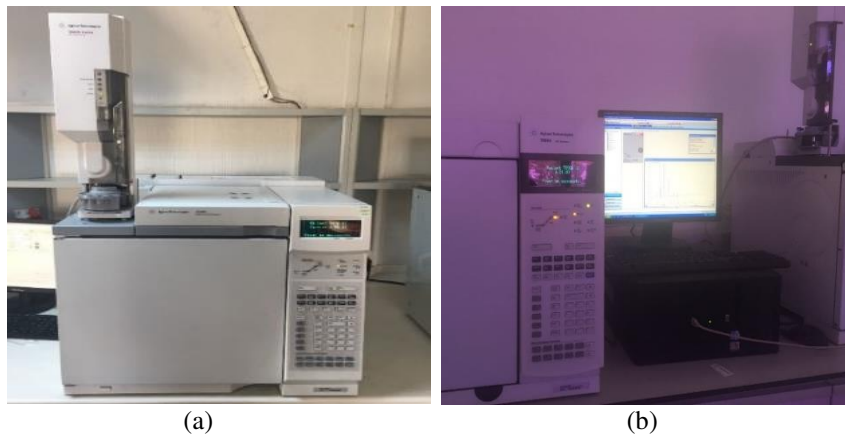
Şekil 2.16 (a) Agilent 6890N (b) Agilent 7890A GC cihazları
