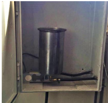
Şekil 2.38 Yakıt deposu ve ölçüm düzeneği
