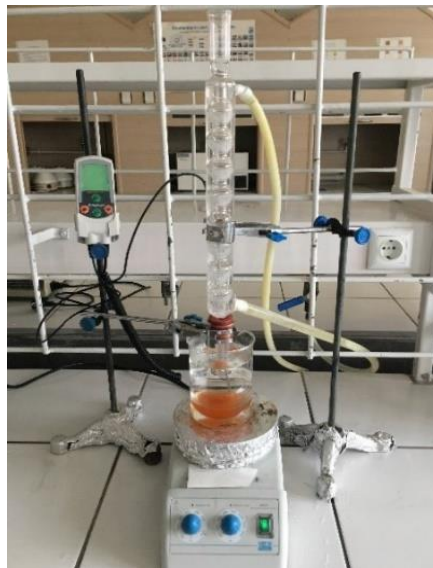
Şekil 2.2 Optimizasyon deneyleri numunesinin reaksiyon düzeneği
