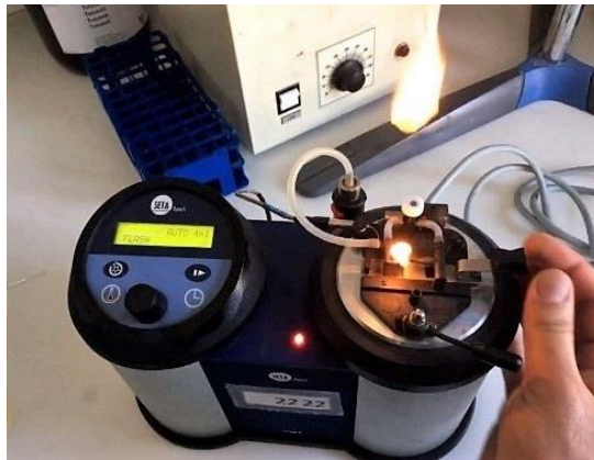
Şekil 2.27 Parlama noktasının bulunması
