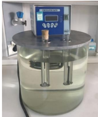
Şekil 2.33 Bakır şerit korozyonu cihazı
