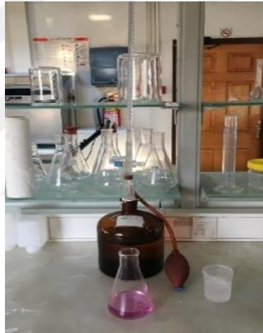
Şekil 2.20 Asit sayısı tayini titrasyon sonrası
