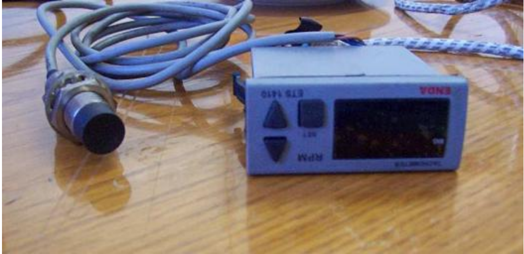
Şekil 5.7. Motor devir sensörü ve göstergesi
