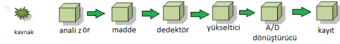
Şekil 3.11: Kırmızıaltı (IR) Spektrometrenin blok diyagramı.
