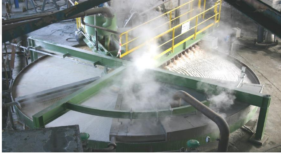
Şekil 2.9. Eti Alüminyum A.Ş. Fabrikasında alüminyum trihidroksit üretim filtresi
