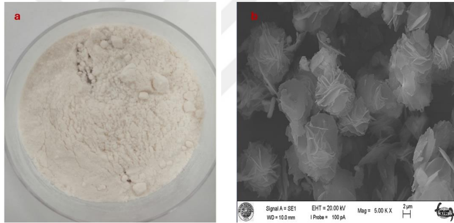
Şekil 4.1. Derişik lityum kekinin a) fiziksel görünümü b) SEM görüntüsü
