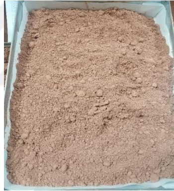
Şekil 4 6. Pilot tesisten elde edilen derişik lityum keki
