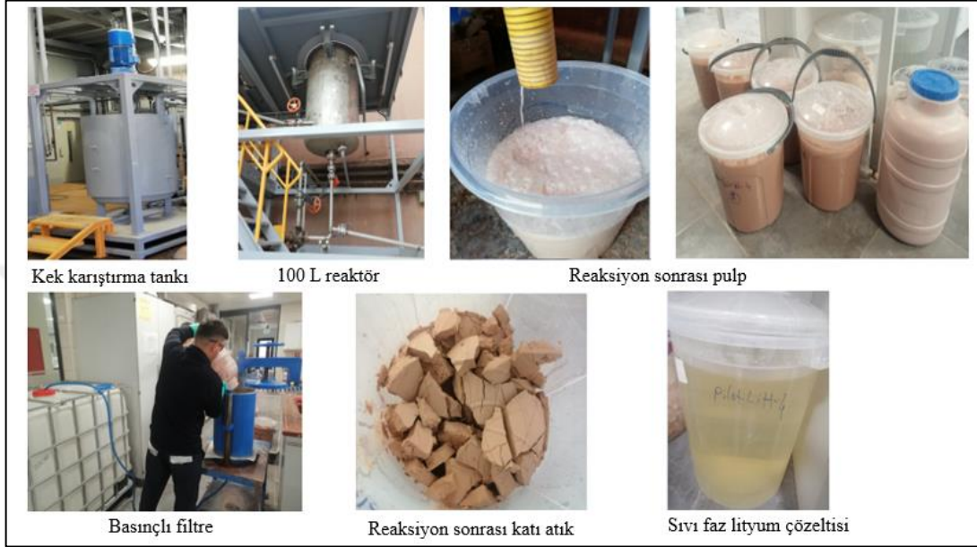
Şekil 4.29. Pilot tesiste derişik lityum kekinden lityum çözeltisi elde etme aşamaları
