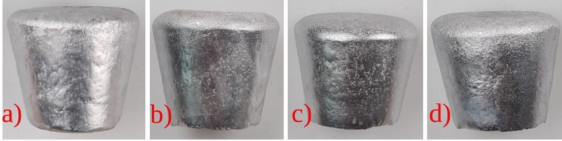
Şekil 23: RPT Test Numune Görüntüleri a) İlavesiz, b) %0,03 V İlaveli, c) %0,05 V İlaveli, d) %0,1 V İlaveli
