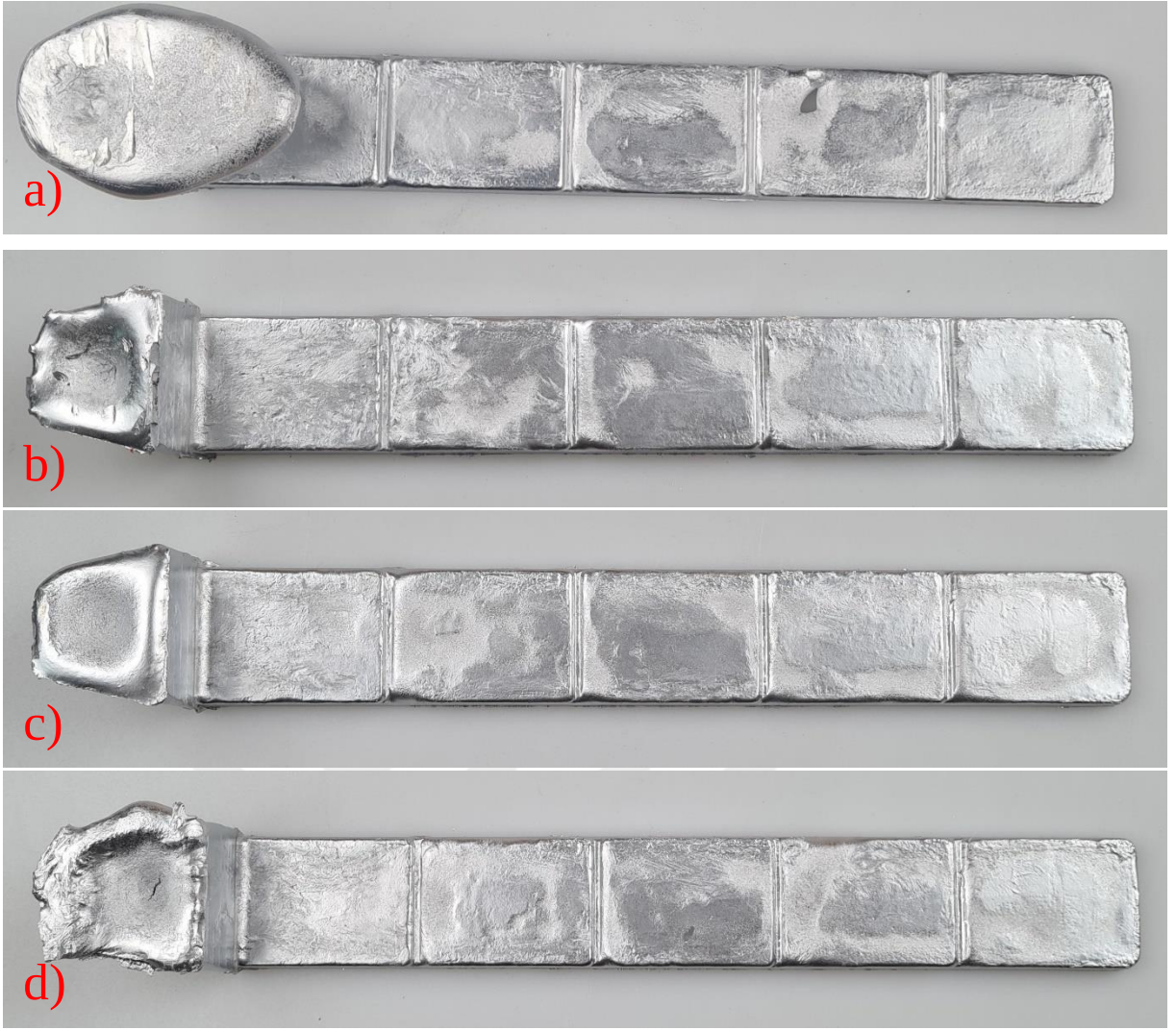
Şekil 25: K-mold Kalıbında Yapılan Döküm Deneyleri Görüntüleri a) İlavesiz, b) %0,03 V İlaveli, c) %0,05 V İlaveli, d) %0,1 V İlaveli
