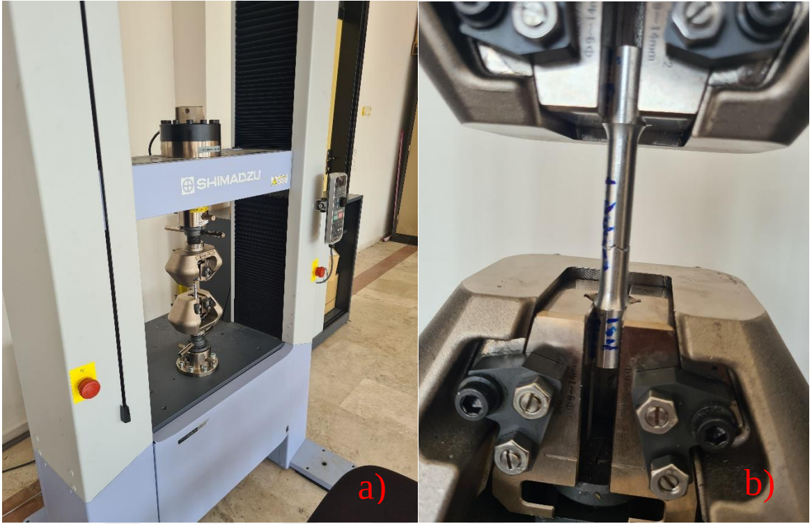
Şekil 20: a) Çekme Deneyi Cihazı, b) Çekme Deneyi Numunesi
