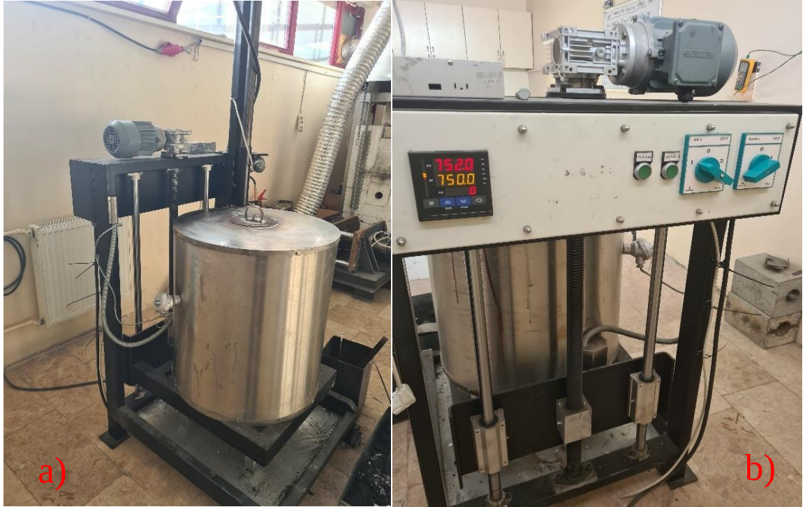
Şekil 7: a) Elektrik Direnç Ocağı, b) Döküm Ocağı Ön Yüz
