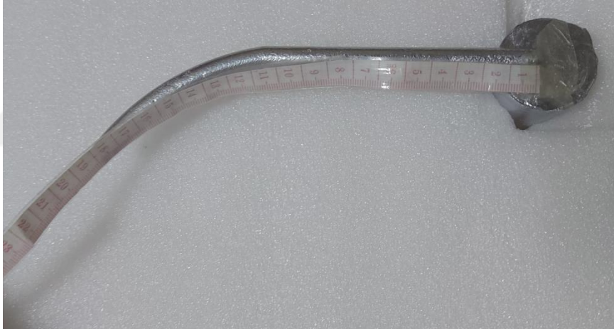
Şekil 25: Sıvı Metal İlerleme Mesafelerinin Ölçülmesi
