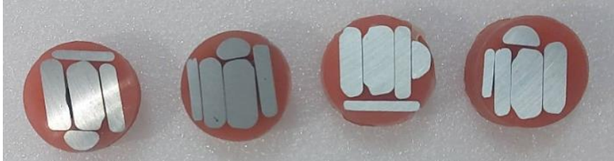
Şekil 31: Mikroyapı Numunelerini Bakalite Alınması ve Numune Örnekleri
