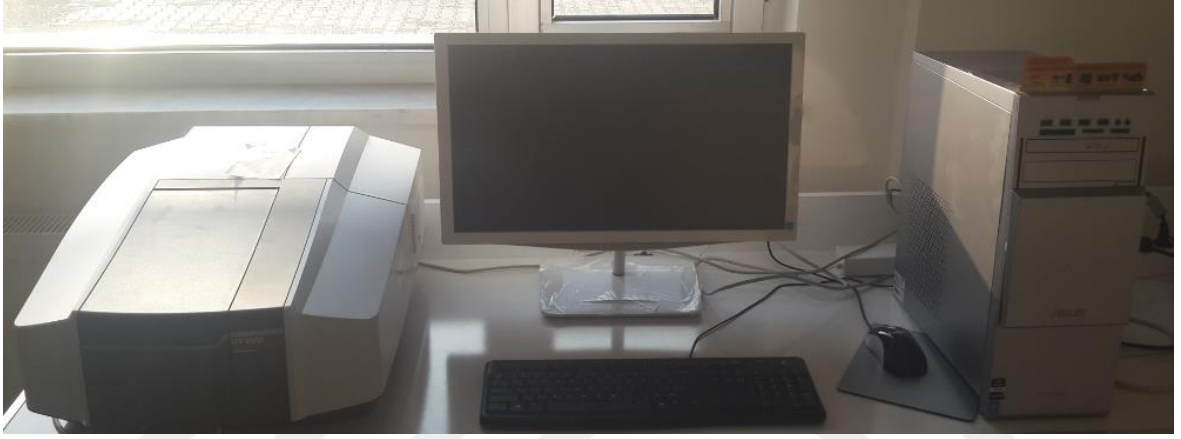
Şekil 3.10. Ultraviyole ve görünür ışık (UV-Vis) absorpsiyon spektroskopi cihazı
