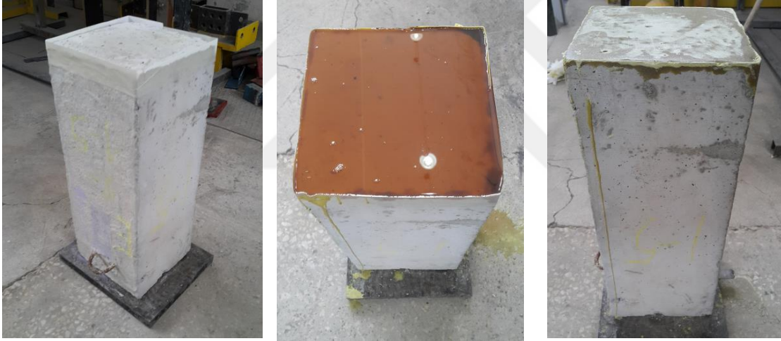
Şekil 2.16. Deney kolonlarının tabanına kükürt tabaka uygulanması
