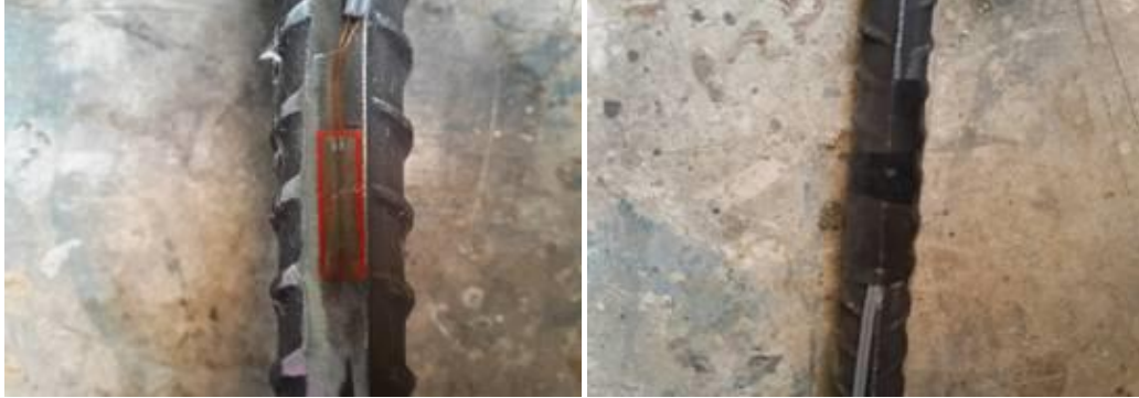
Şekil 2.1 Eğilme donatılarına şekil değiştirme ölçer yapıştırılması aşamaları
