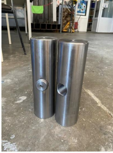
Görsel 3.11. Mafsal takozuna ve millere dış açılma işlemi
