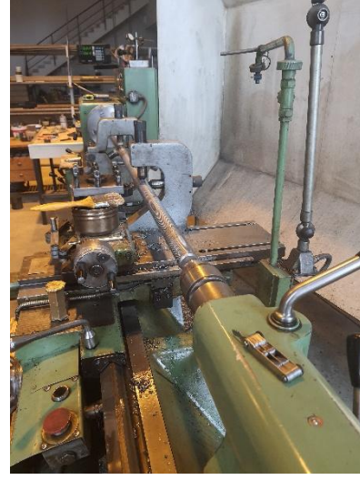
Görsel 3.11. Mafsal takozuna ve millere dış açılma işlemi
