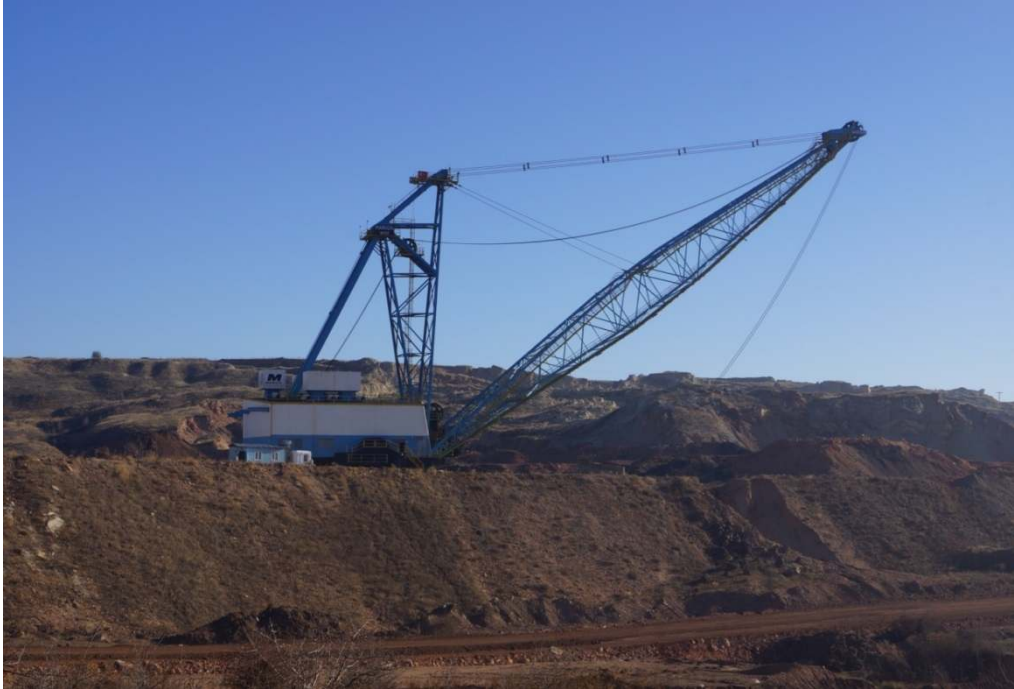
Şekil 6.8 İşletmede bulunan dragline (Marion 8050)
