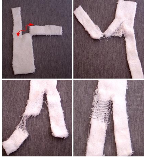
Şekil 2.2 Havluların yırtılma testi sırasında farklı yırtılma örnekleri
