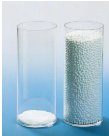
Şekil 2.1 : Polistren malzemenin baz ve genleştirilmiş hali [12].
