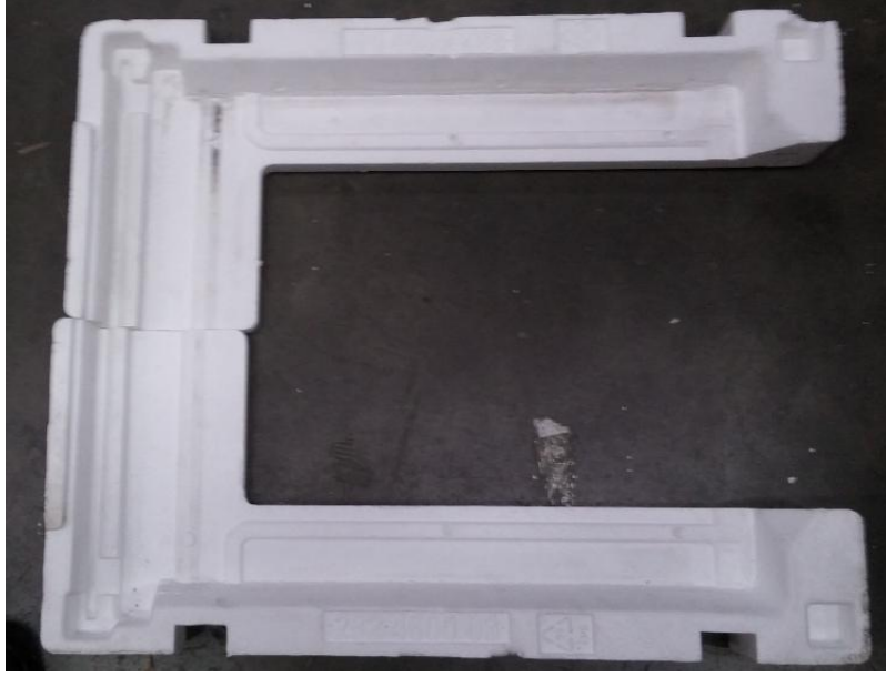
Şekil 4.7 : 40 cm’den düz düşme sonucu genişletilmiş polistren malzemenin son hali.
