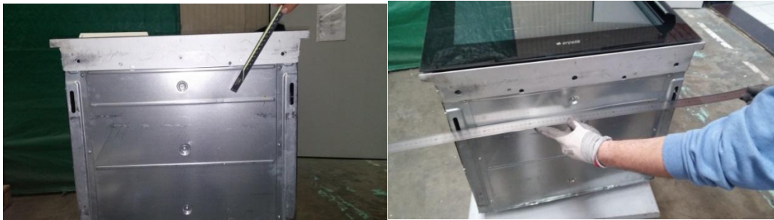
Şekil 4.4 : 40 cm'den düz düşme sonucu taban sacındaki eğilme.
