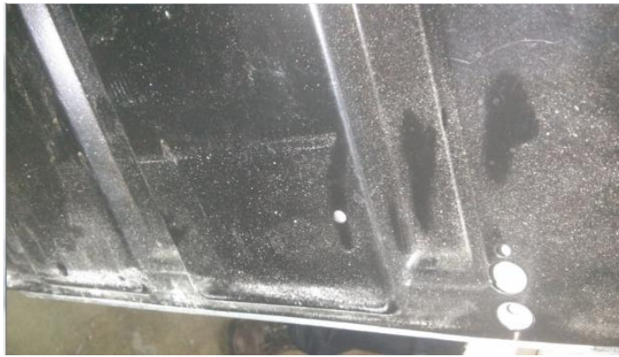
Şekil 5.7 : 70 cm'den düz düşme sonucu yan saclarda görülen EPS izleri.
