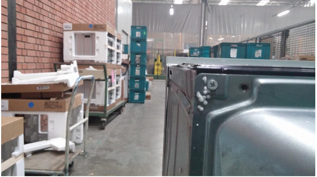
Şekil 5.4 : 40 cm'den sağ kenar üzerine düşme sonucu alt sacta oluşan eğilme.
