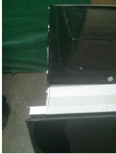
Şekil 5.6 : 70 cm'den düz düşme sonucu tavan sacında oluşan ayrılma.
