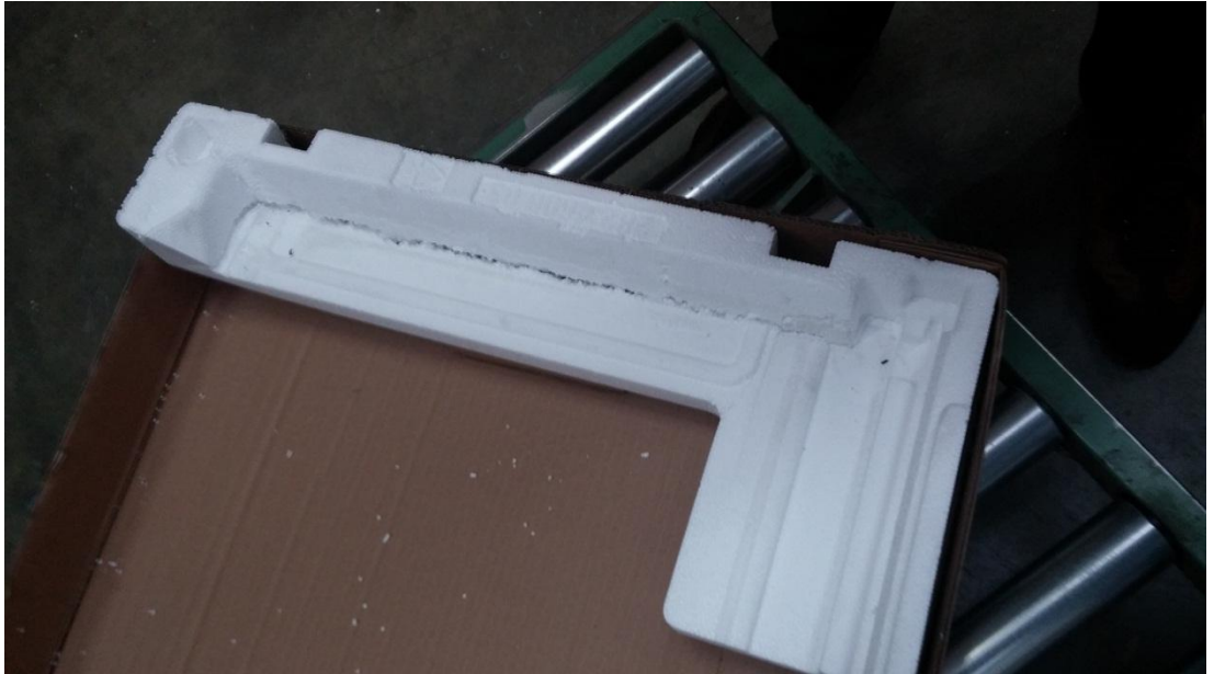
Şekil 5.5 : 40 cm'den sağ kenar üzerine düşme sonucu genişletilmiş EPS parçada görülen kırılma.
