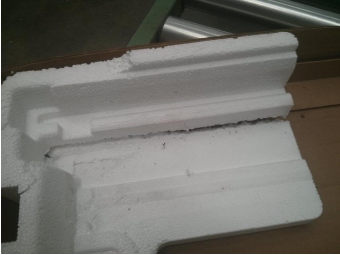
Şekil 5.3 : 40 cm'den ön kenar üstüne düşme sonucu genişleştirilmiş polistrende oluşan kırılma.
