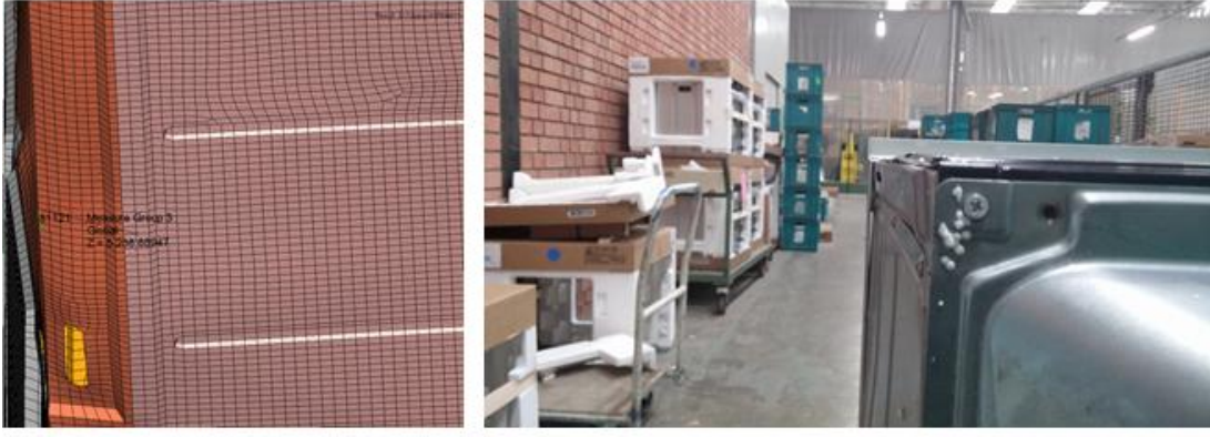
Şekil 6.2 : Sayısal yaklaşımla taban sacında hesaplanan şekil değişiminin test ile karşılaştırılması.
