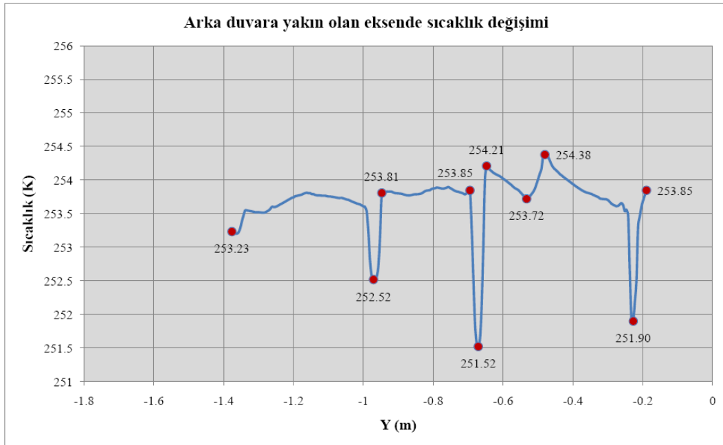
Şekil 6.25 Arka duvara yakın olan eksende sıcaklık değişim grafiği
