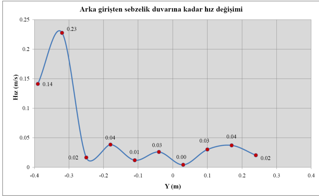
Şekil 6.10 Arka girişten sebzelik duvarına kadar hız değişim grafiği
