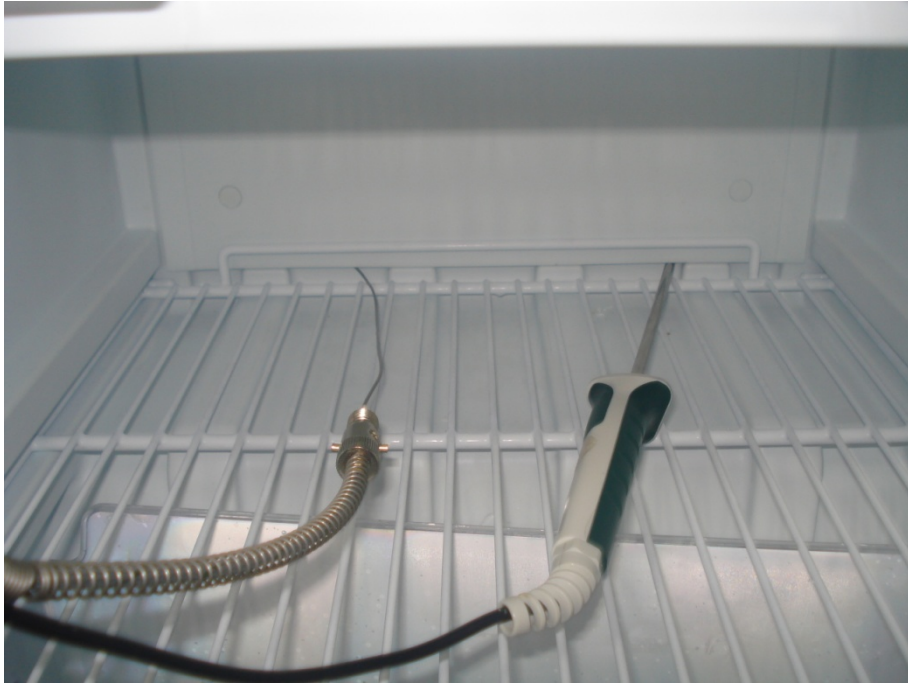
Şekil 4.5 En altaki hava kanal kapağı ve gövde plastiği arasındaki açıklıktan sıcaklık ve hız ölçümü
