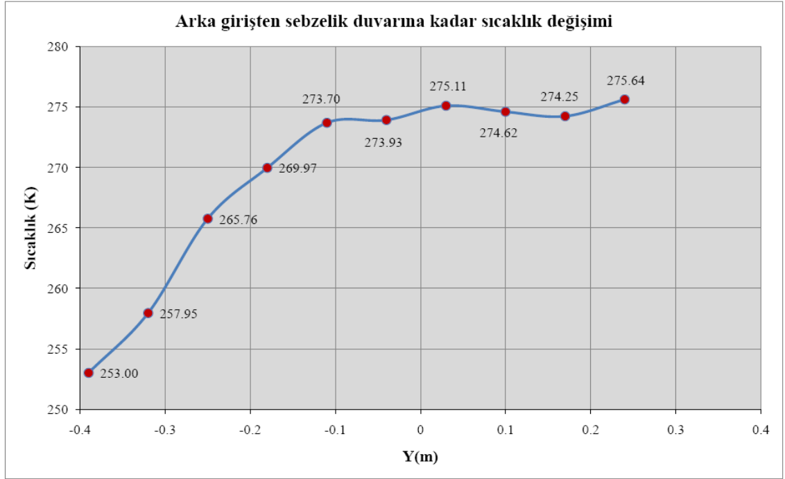
Şekil 6.5 Arka giriş bölgesinden sebzelik duvarına kadar olan sıcaklık değişim grafiği
