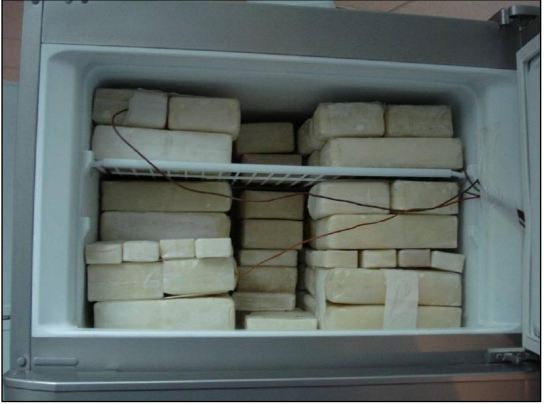
Şekil 3.11 Enerji ölçümü testlerinde kullanılan deney ve M paketleri (Yılmaz, 2008)
