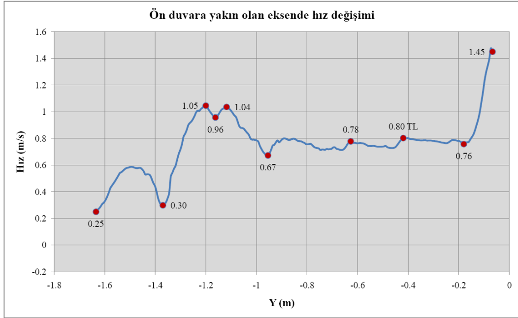
Şekil 6.26 Ön duvara yakın olan eksende hız değişim grafiği
