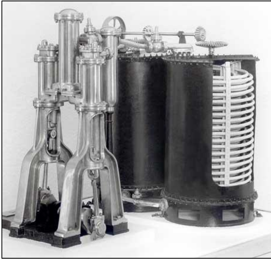
Şekil 1.2 Trieste bira fabrikasında kullanılan Linde modeli ( http://www.linde-engineering.com/first-refrigerating-machine.php )
