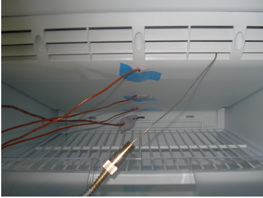
Şekil 4.4 Buharlaştırıcı kapağı duvarına bağlanan K tipi ısıl çiftler ve buharlaştırıcı üzerinden geçen havanın sıcaklığını ölçmek için bağlanan daldırma tip ısıl çift
