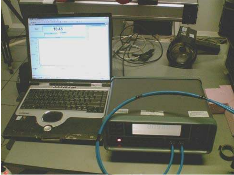
Şekil 4.6 Debi ölçümünde kullanılan dijital manometre ve bilgisayar
