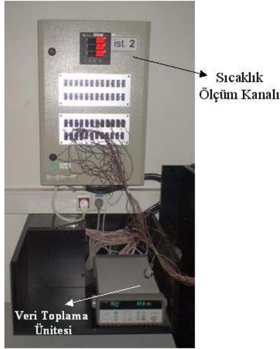
Şekil 4.4 Veri toplama ünitesi ve sıcaklık ölçüm kanalının gösterilmesi
