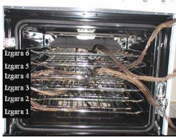
Şekil 5.2 Fırın şasisi içinde ızgaraların yerleşimi
