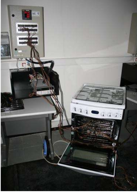
Şekil 7.3 (a) Deneyde kullanılan fırın, fırın içine yerleştirilen ızgaralar ve veri toplama ünitesi, (b) Deneysel çalışma ve analiz çalışması sonrasında sıcaklık dağılım grafiğinin çizilebildiği alanlar
