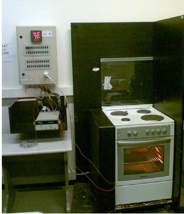
Şekil 4.2 Enerji tüketimi deney düzeneğinin görünüşü
