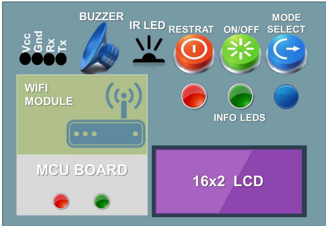
Şekil 2.10 Uzaktan erişim ve kontrol kartının sahip olduğu donanım ve komponent dizgi yerleşim planı
