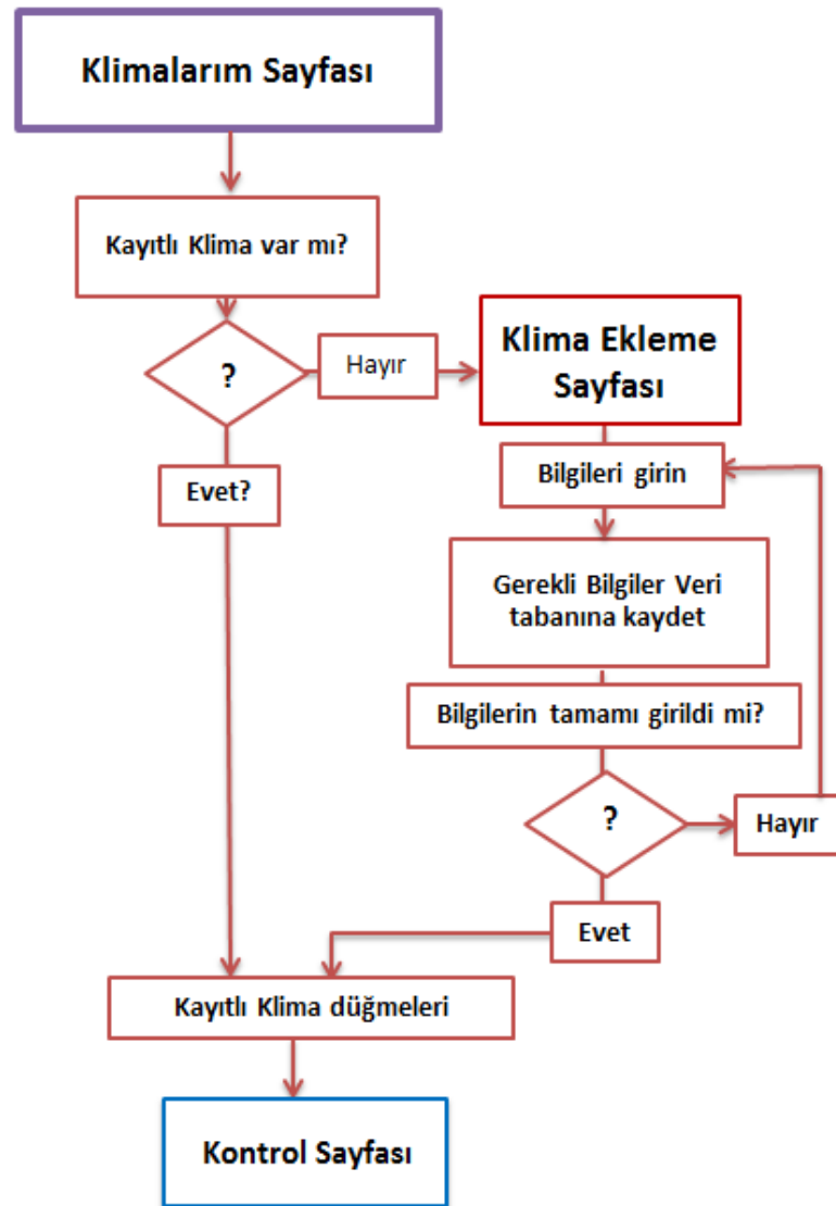
Şekil 3.16 Klimalarım ve klima ekleme yazılımı akış şeması
