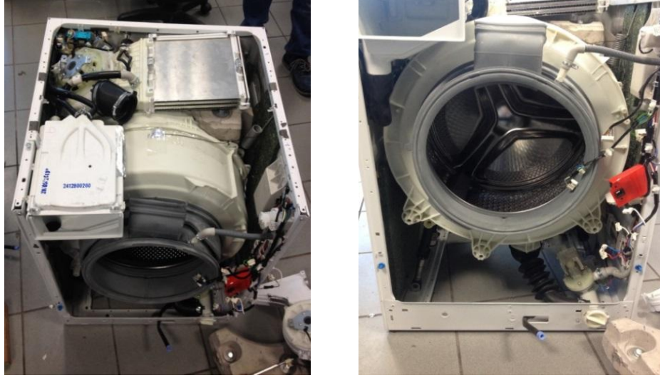
Şekil 4.2 Yıkayıcı-kurutucu makinenin üzerine ısıl çiftler eklenmeden önce üstten ve önden görünüşü.
