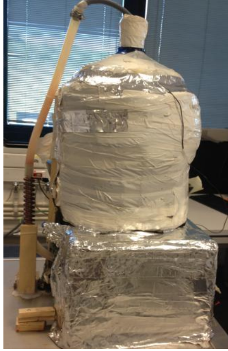
Şekil 4.18 Flowthrough ısıtıcıların verimlilik analizlerinin yapıldığı deney düzeneği. 1. yasa verim hesabı yapılarak ısıtıcıların verimleri belirlenmiştir. Verimlilik analizleri yapılan ısıtıcılar Şekil 4.19’ da gösterilmiştir.
