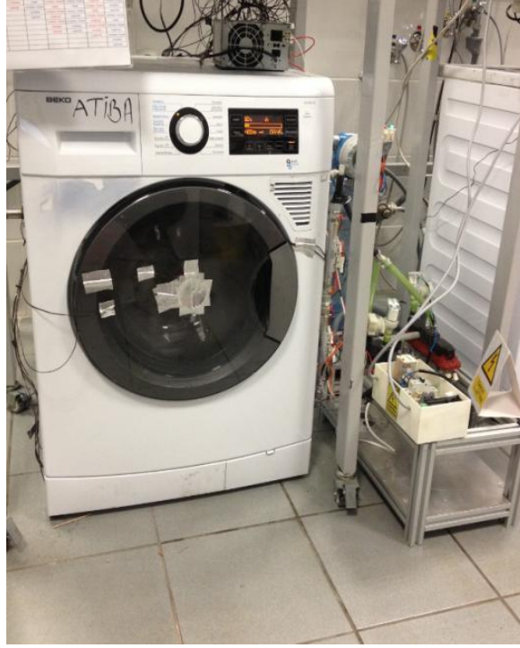
Şekil 4.13 Buhar jeneratörleri kullanılarak hazırlanan deney düzeneği.
