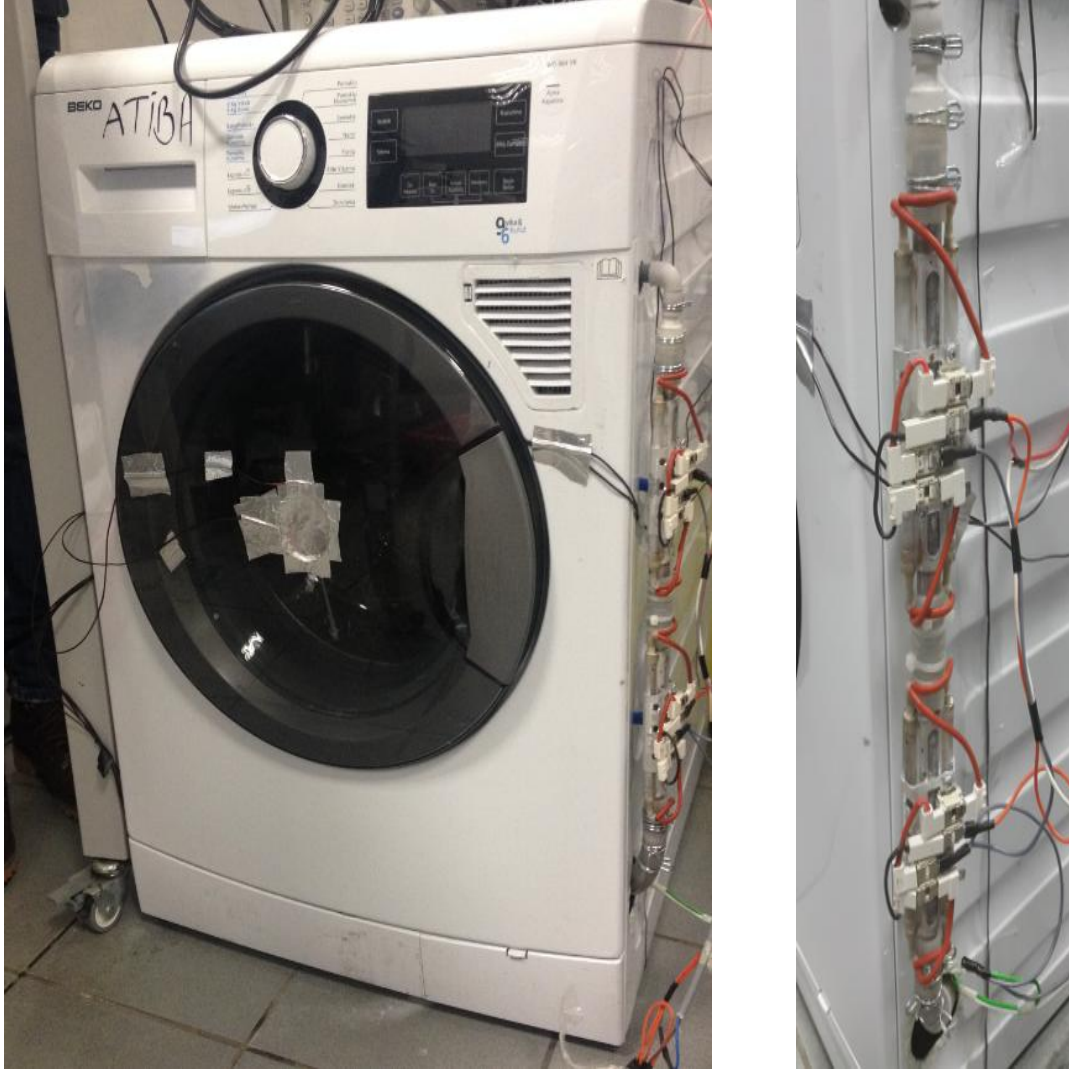
Şekil 4.20 Flowthrough ısıtıcı kullanılarak hazırlanan deney düzeneği.
