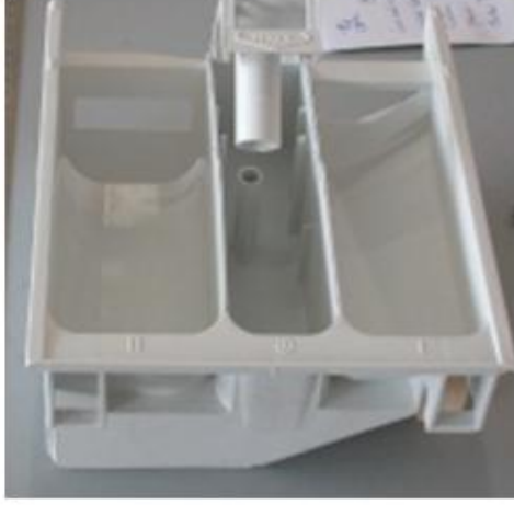
Şekil 3.2 Ev tipi yıkayıcı-kurutucu makinedeki deterjan çekmecesini ve kazan-çekmece arası bağlantı hortumu. [16]
