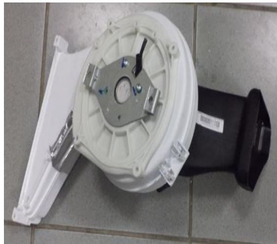
Şekil 3.8 Ev tipi yıkayıcı-kurutucu makinelerde bulunan soğutma fanı.
