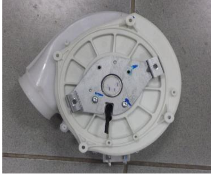
Şekil 3.9 Ev tipi yıkayıcı-kurutucu makinelerde bulunan proses fanı.
