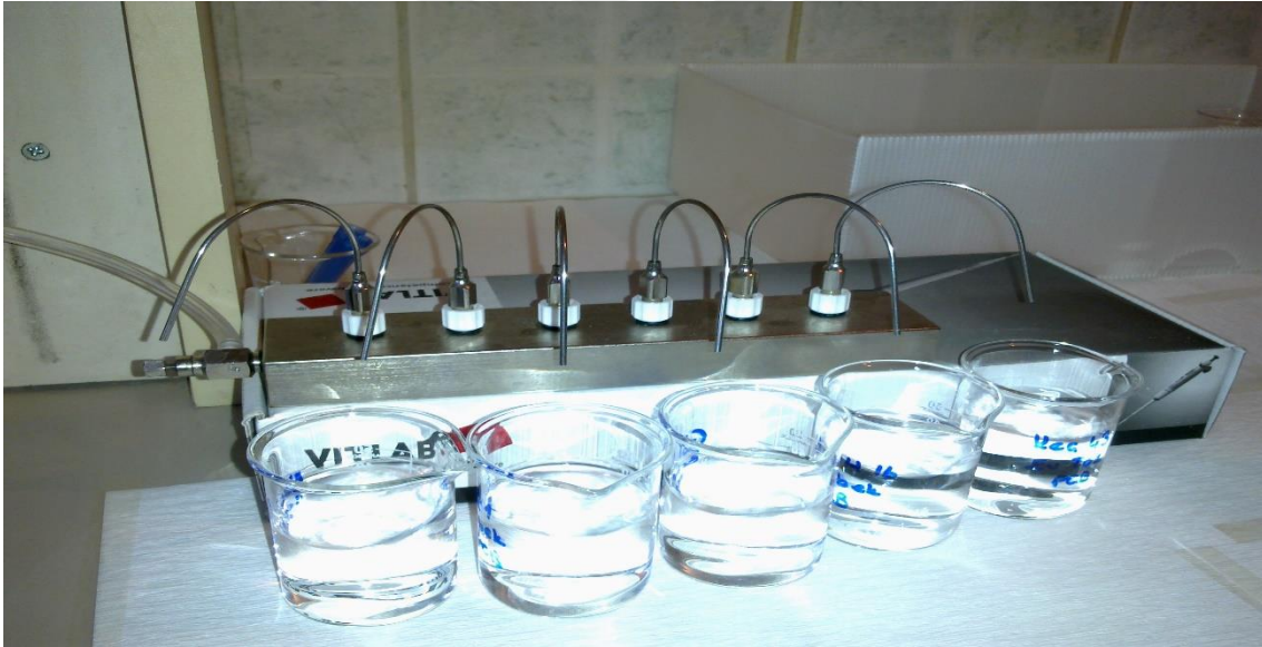
Şekil 4.2: Ön zenginleştirme işlemi
