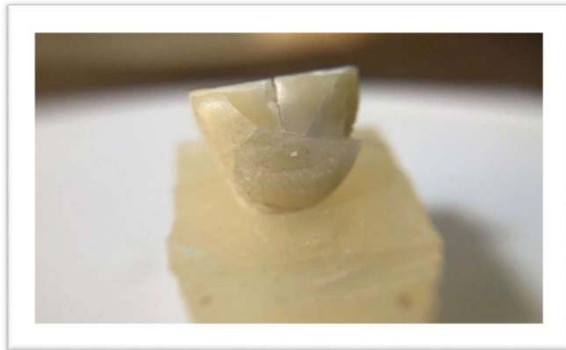
Resim 21: Kırılan örnek (miks kopma)
