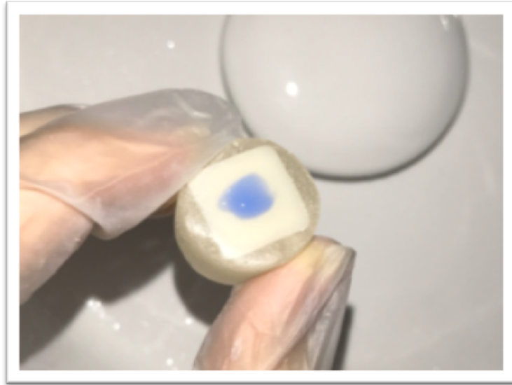
Resim 3.6. K-ETCHANT Syringe'nın seramik yüzeyine uygulanması
