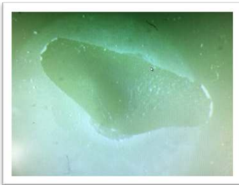
Resim 3.26. a) ve b) Tip II: Koheziv kopma
