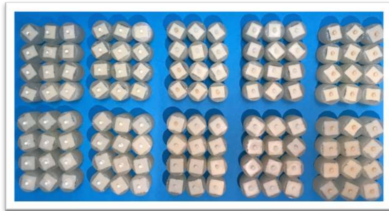
Resim 3.21. Simantasyonu tamamlanmış seramik örnekler
