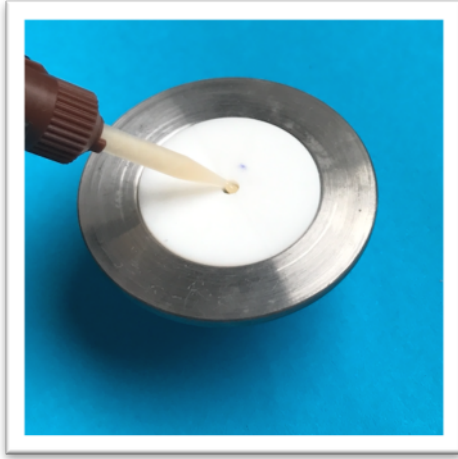
Resim 3.19. a) ve b) Rezin simanın kalıp içine uygulanması ve polimerizasyonu
