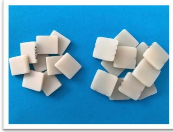
Resim 3.3. Hassas kesim cihazında hazırlanmış seramik örnekler
