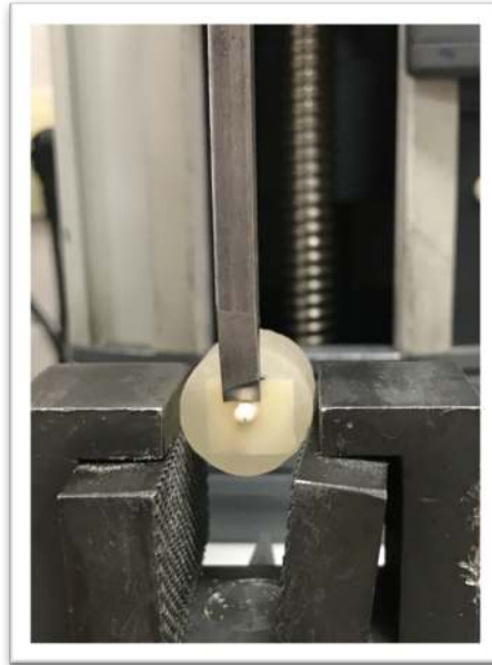
Resim 3.24. a) ve b) Makaslama testinin uygulanması
