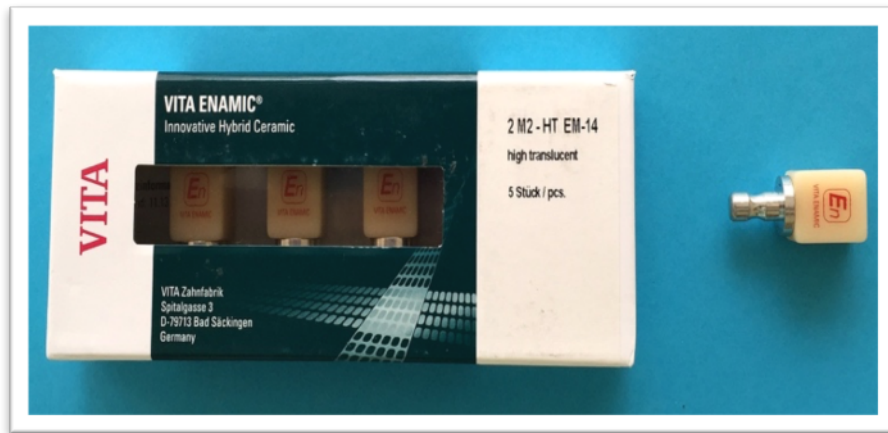
Rsim 3.2. Çalışmada kullanılan Vita Enamic CAD/CAM blok materyali
