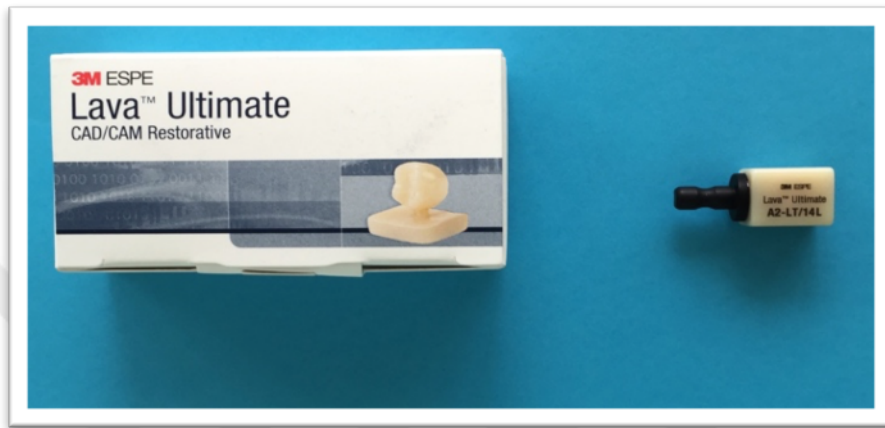
Resim 3.1. Çalışmada kullanılan Lava Ultimate CAD/CAM blok materyali
