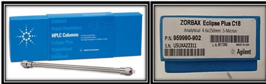
Resim 7. Agilent ZORBAX Eclipse XDB columns-C18 ters faz analiz kolonu
