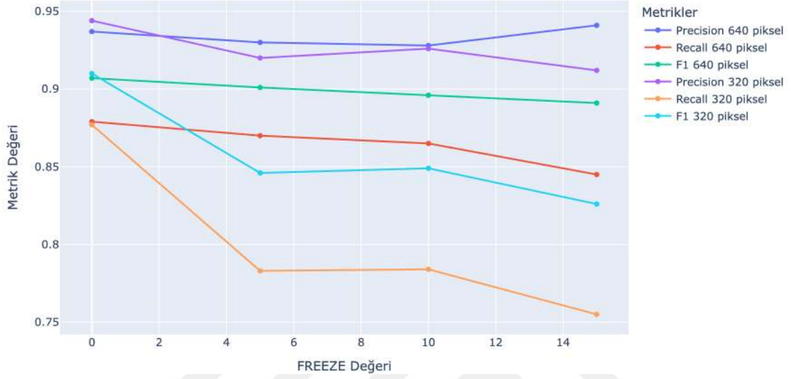
Şekil 5.7: YOLOv11 modelinin 640 ve 320 piksel çözünürlüklerde FREEZE parametresine göre Precision, Recall ve F1 skorlarının değişimi
