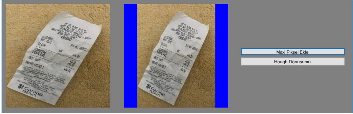
Şekil 3.30. Fatura görüntü işleme ekranında mavi piksel ekleme uygulaması
