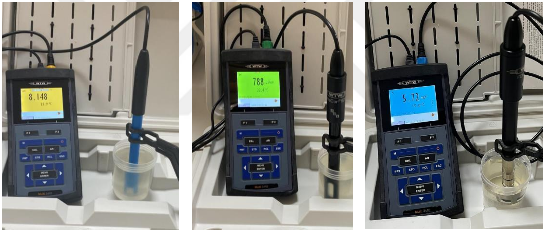
Şekil 4.5. pH , elektriksel iletkenlik, çözülmüş oksijen ölçümleri
