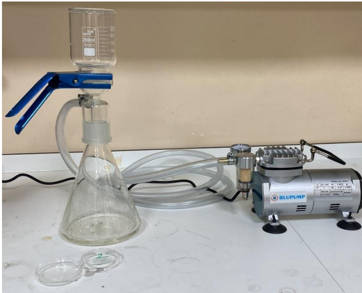
Şekil 4.6. Askıda katı madde deneyinde süzme işlemi
