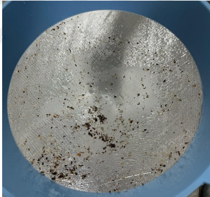
Şekil 4.4. Elekten geçirilmiş ham gri su numunesinin elekte kalan kısmı
