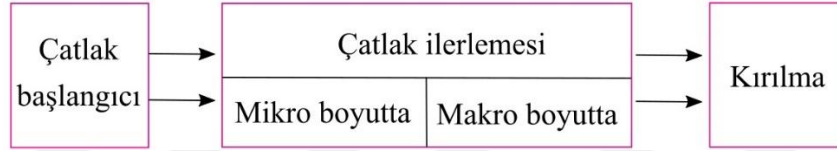
Şekil 15. Yorulma kırılmasının oluşum şeması (Suresh, 1998)
