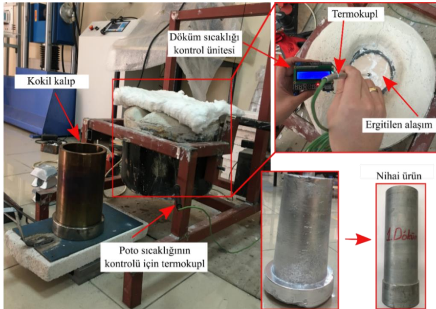
Şekil 19. Ergitme İşleminde kullanılan ısı kontrollü pota fırını
