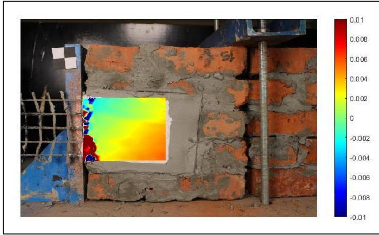
Şekil 3.59. #15 deney elemanına ait birim deformasyon dağılımı (y-y doğrultusu)
