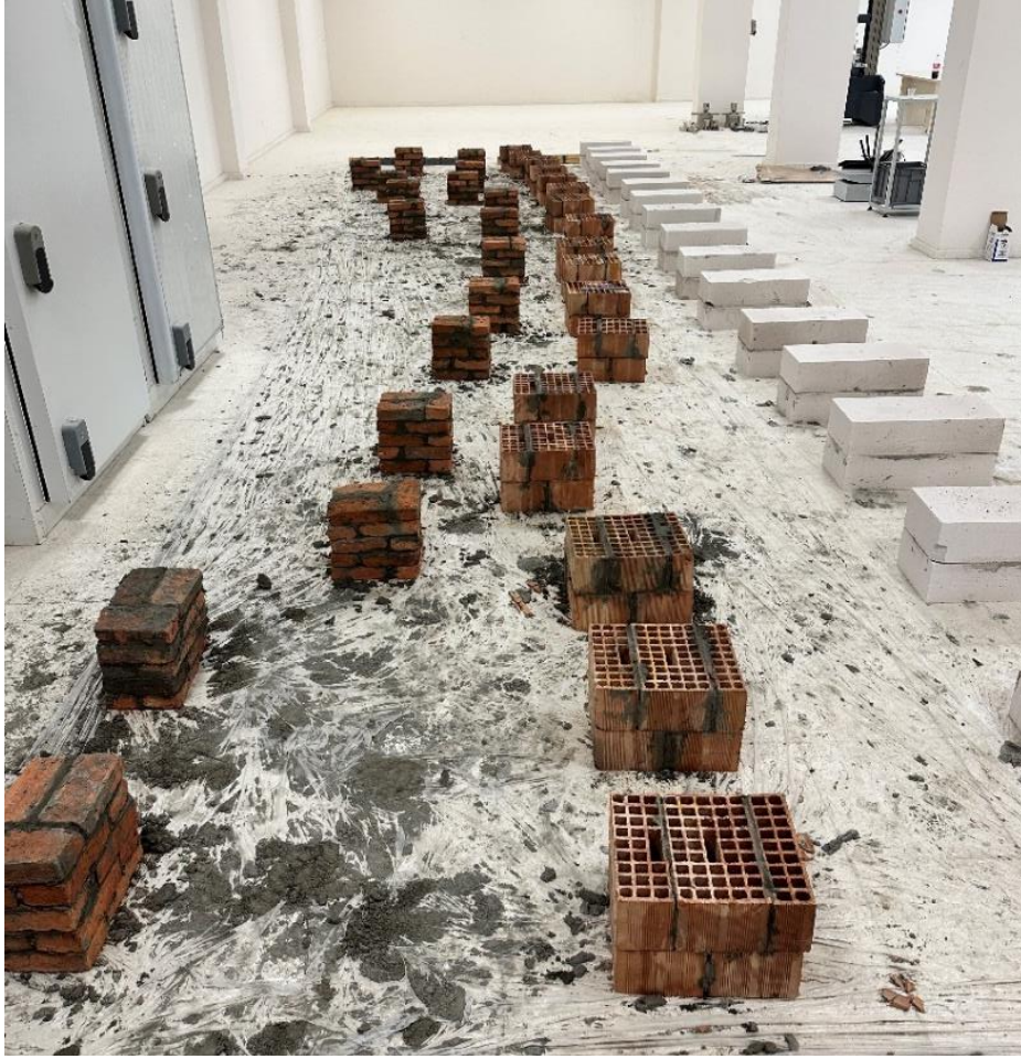
Resim 2.6. Üretilen 48 adet deney elemanı
