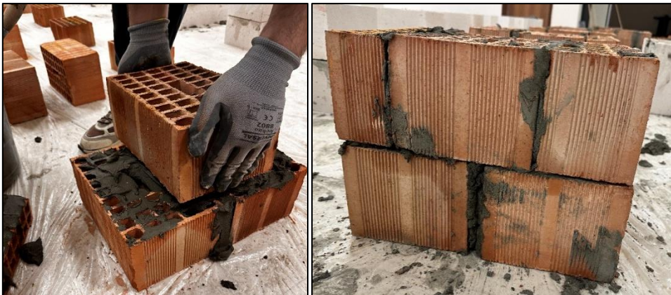
Resim 2.3. Boşluklu tuğladan oluşan duvar numunelerinin üretimi
