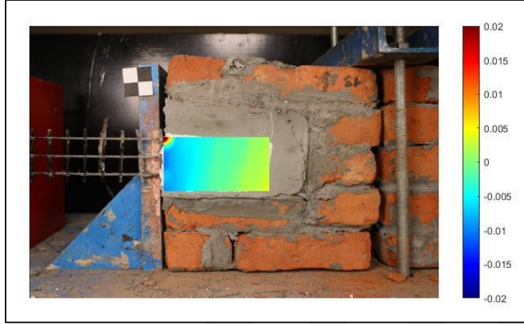
Şekil 3.50. #13 deney elemanına ait birim deformasyon dağılımı (x-x doğrultusu)
