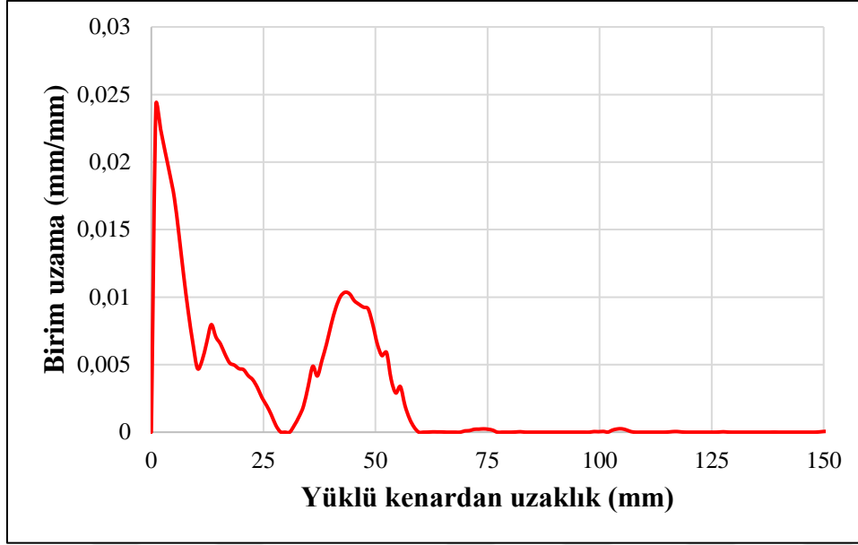
Şekil 3.184. #46 deney elemanına ait şerit boyunca birim uzama dağılımı (x-x)
