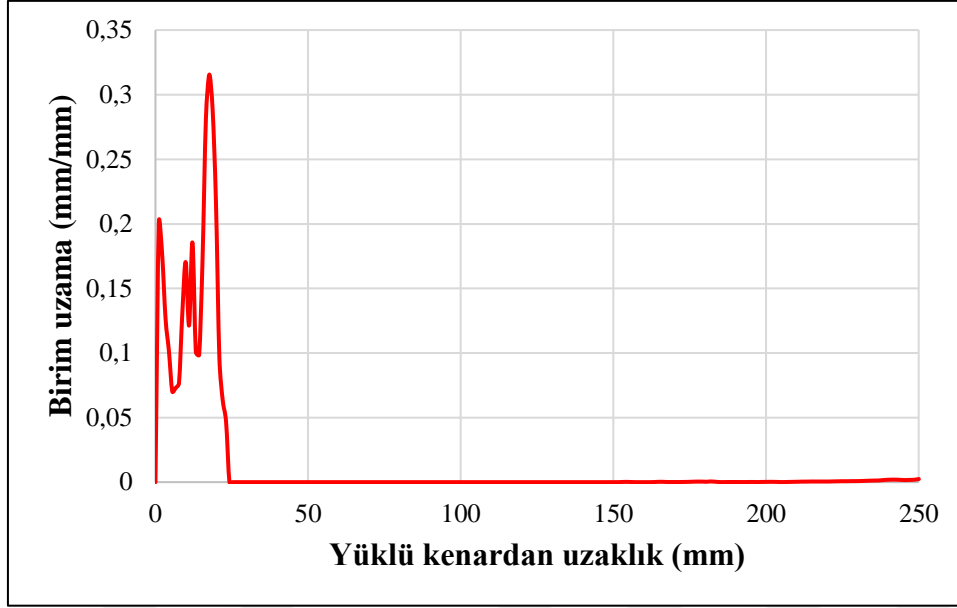
Şekil 3.160. #40 deney elemanına ait şerit boyunca birim uzama dağılımı (x-x)
