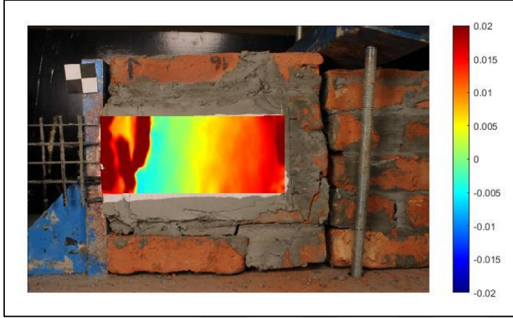
Şekil 3.62. #16 deney elemanına ait birim deformasyon dağılımı (x-x doğrultusu)
