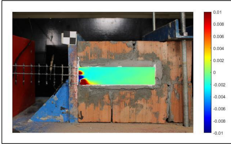
Şekil 3.23. #6 deney elemanına ait birim deformasyon dağılımı (y-y doğrultusu)
