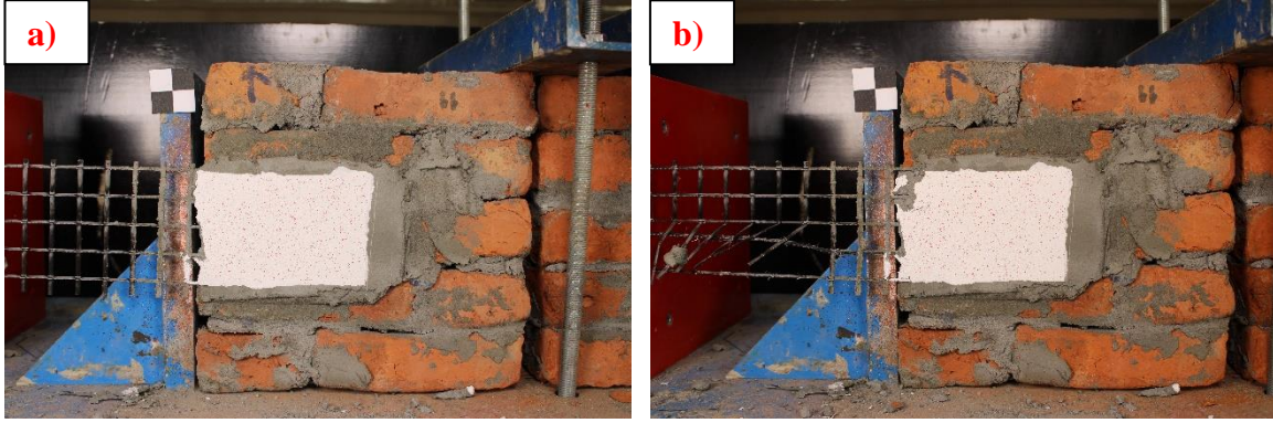
Resim 3.11. #11 deney elemanı: a) göçme öncesi, b) göçme sonrası
