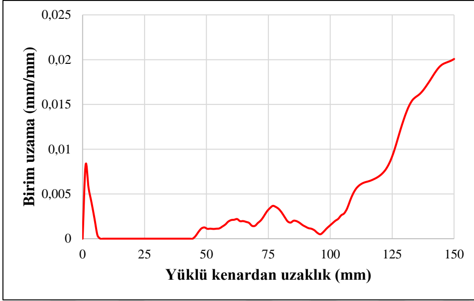
Şekil 3.172. #43 deney elemanına ait şerit boyunca birim uzama dağılımı (x-x)
