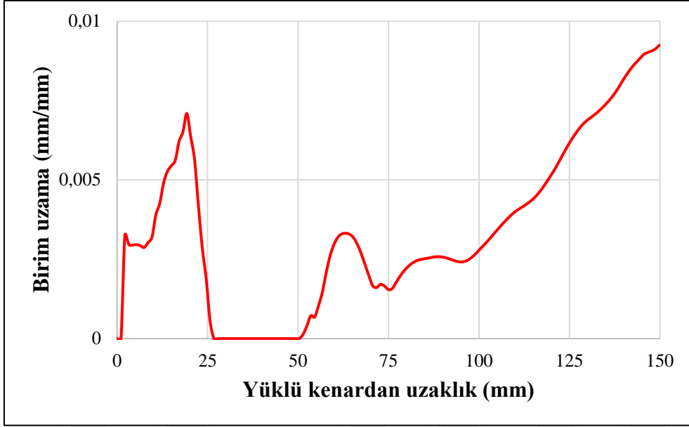
Şekil 3.28. #7 deney elemanına ait şerit boyunca birim uzama dağılımı (x-x)
