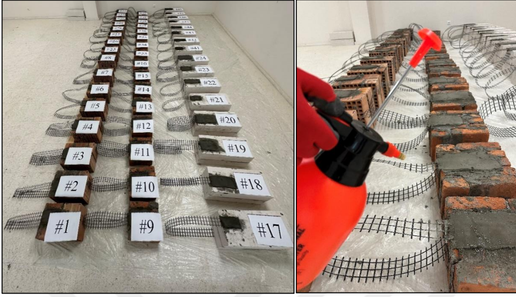
Resim 2.13. Deney elemanlarının uygun sıcaklık ve nemde kürlenmesi
