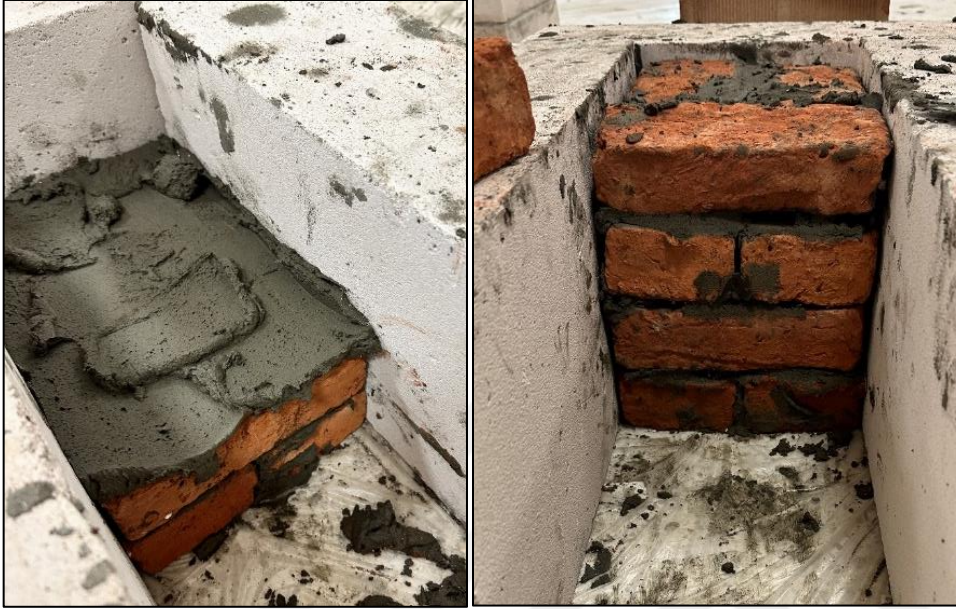
Resim 2.4. Dolu harman tuğlasından oluşan duvar numunelerinin üretimi
