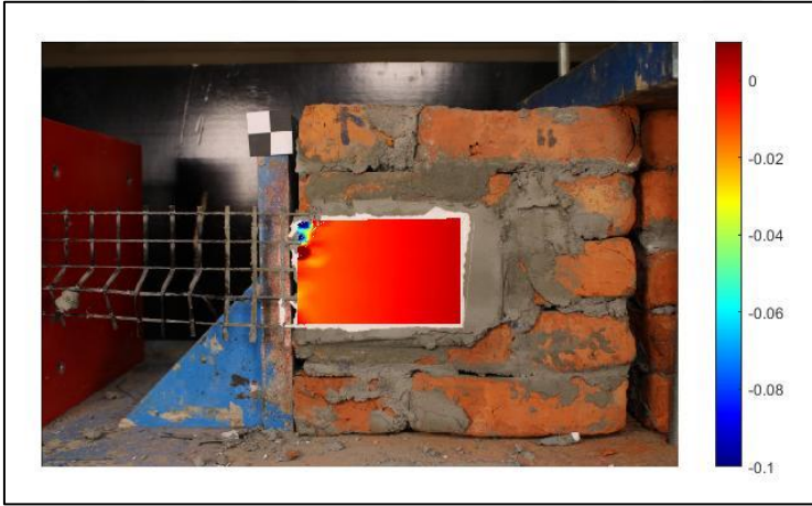
Şekil 3.43. #11 deney elemanına ait birim deformasyon dağılımı (y-y doğrultusu)
