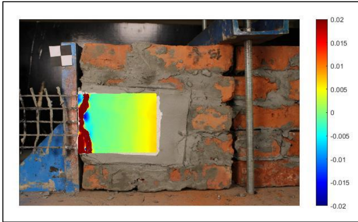
Şekil 3.58. #15 deney elemanına ait birim deformasyon dağılımı (x-x doğrultusu)
