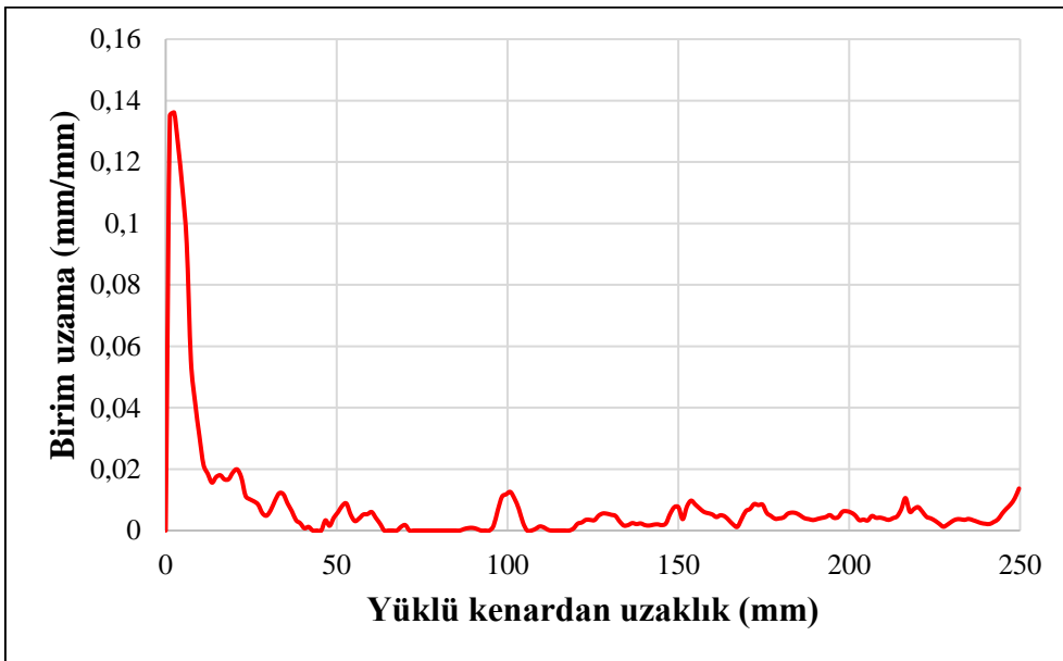
Şekil 3.32. #8 deney elemanına ait şerit boyunca birim uzama dağılımı (x-x)
