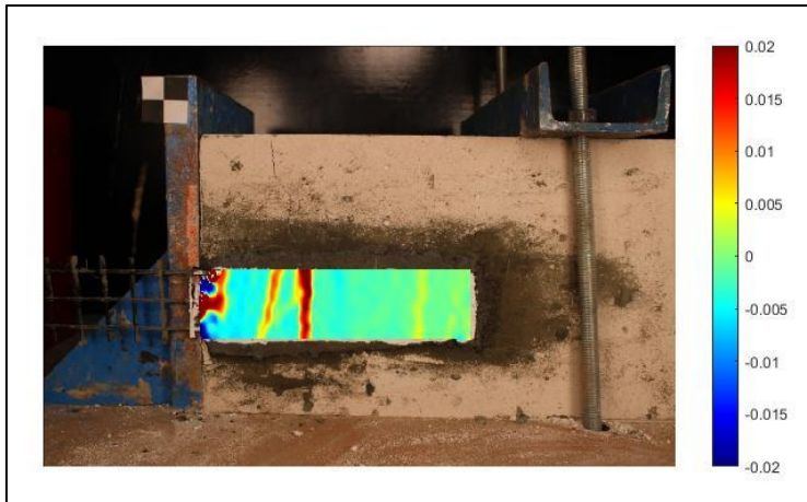
Şekil 3.166. #42 deney elemanına ait birim deformasyon dağılımı (x-x doğrultusu)
