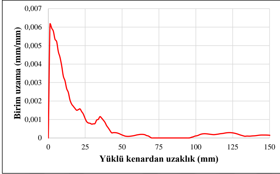
Şekil 3.4 #1 deney elemanına ait şerit boyunca birim uzama dağılımı (x-x)
