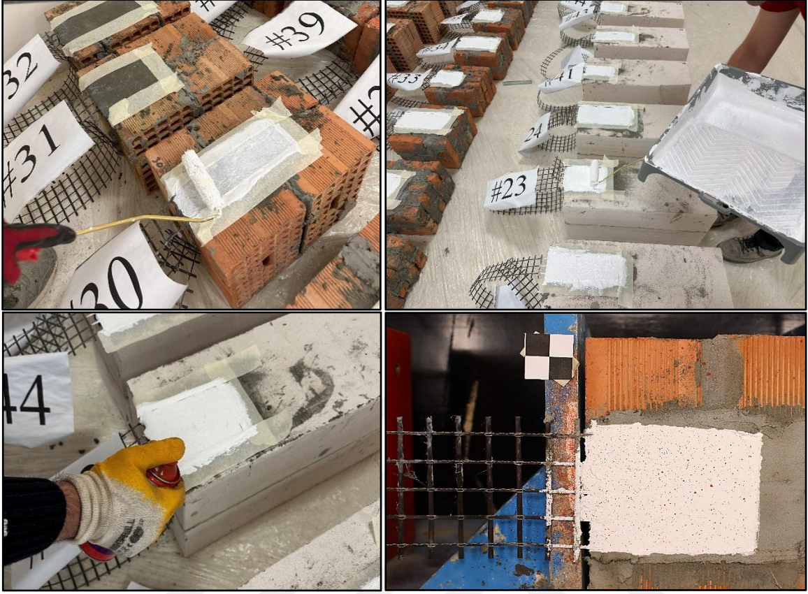
Resim 2.19. Dijital görüntü korelasyonu yöntemi için yüzeylerin hazırlanması
