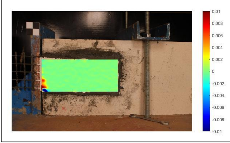
Şekil 3.191. #48 deney elemanına ait birim deformasyon dağılımı (y-y doğrultusu)
