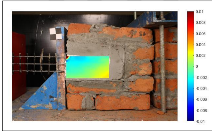
Şekil 3.51. #13 deney elemanına ait birim deformasyon dağılımı (y-y doğrultusu)
