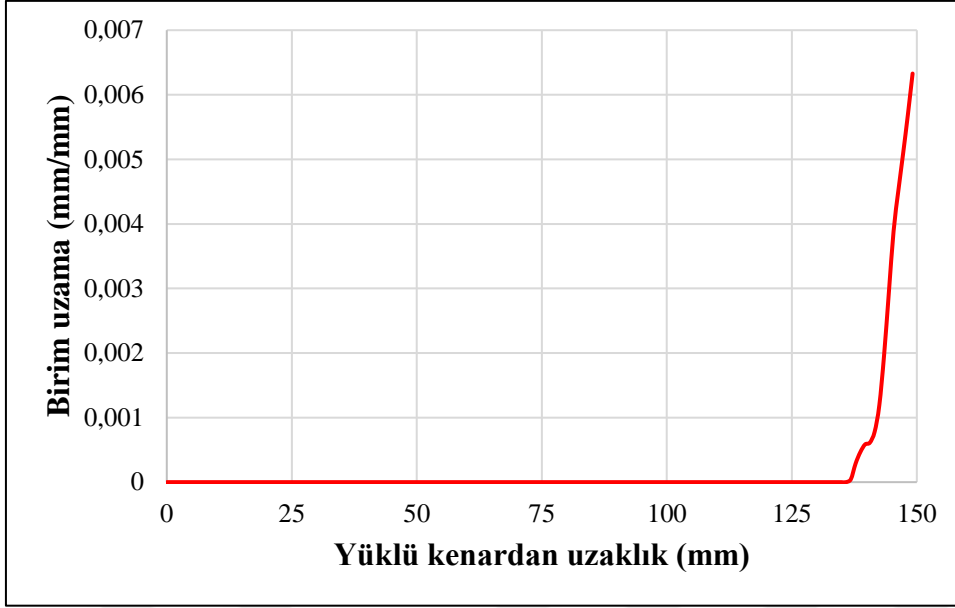
Şekil 3.100. #25 deney elemanına ait şerit boyunca birim uzama dağılımı (x-x)
