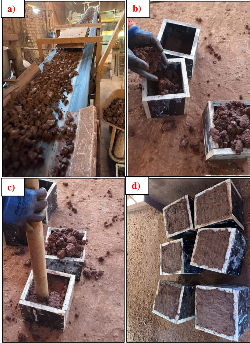
Resim 2.16. Dolu tuğla üretim banından numune alımı
