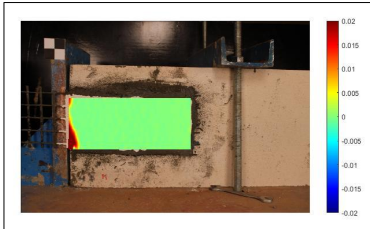
Şekil 3.190. #48 deney elemanına ait birim deformasyon dağılımı (x-x doğrultusu)
