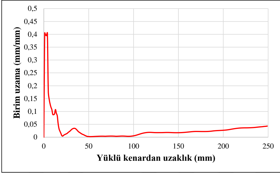
Şekil 3.16 #4 deney elemanına ait şerit boyunca birim uzama dağılımı (x-x)
