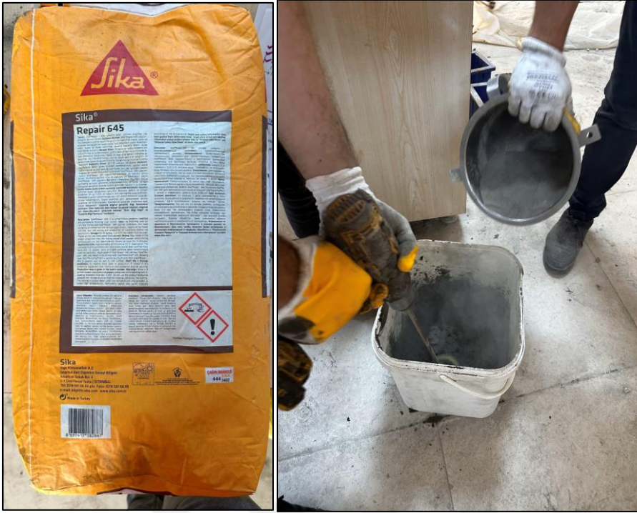
Resim 2.2. Numunelerin üretiminde kullanılan harç ürünü ve hazırlanması
