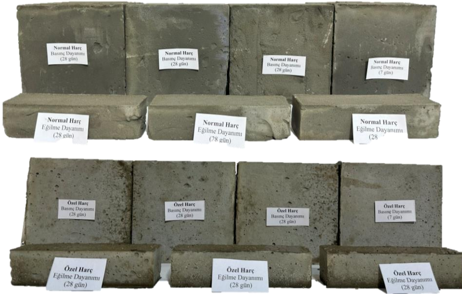
Resim 2.14. Harç mekanik özelliklerinin belirlenmesi için üretilen numuneler
