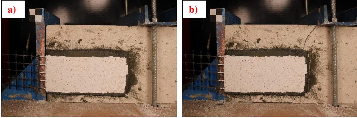
Resim 3.44. #44 deney elemanı: a) göçme öncesi, b) göçme sonrası
