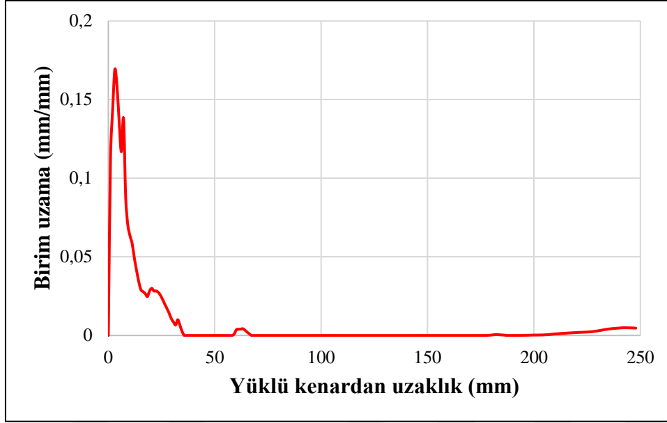
Şekil 3.112. #28 deney elemanına ait şerit boyunca birim uzama dağılımı (x-x)
