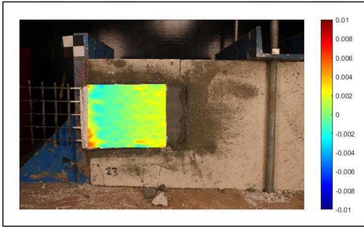
Şekil 3.91. #23 deney elemanına ait birim deformasyon dağılımı (y-y doğrultusu)
