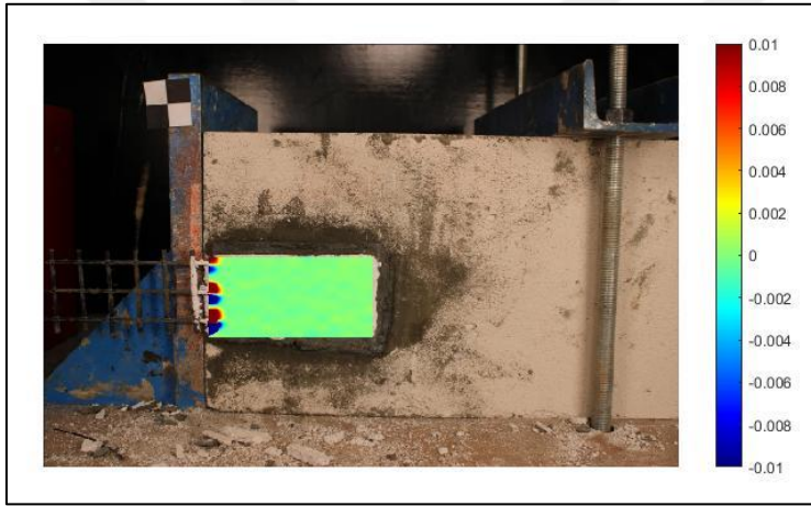
Şekil 3.163. #41 deney elemanına ait birim deformasyon dağılımı (y-y doğrultusu)
