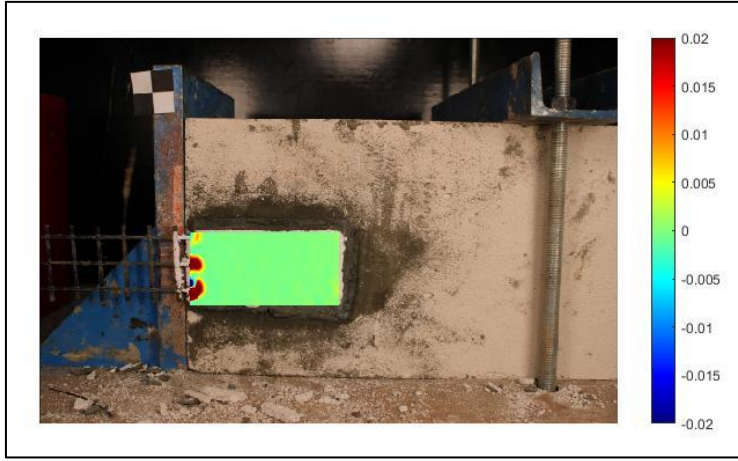
Şekil 3.162. #41 deney elemanına ait birim deformasyon dağılımı (x-x doğrultusu)
