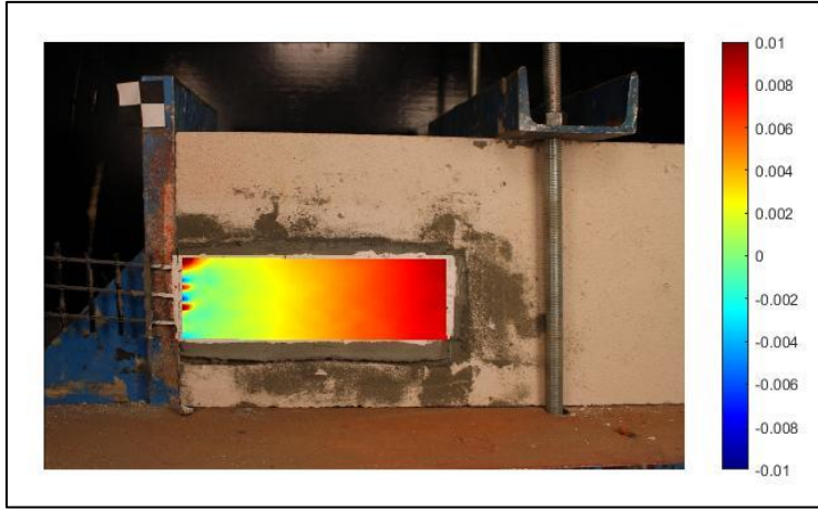
Şekil 3.71. #18 deney elemanına ait birim deformasyon dağılımı (y-y doğrultusu)
