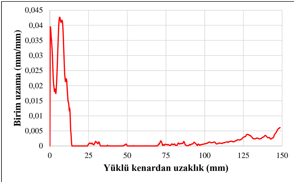
Şekil 3.20. #5 deney elemanına ait şerit boyunca birim uzama dağılımı (x-x)
