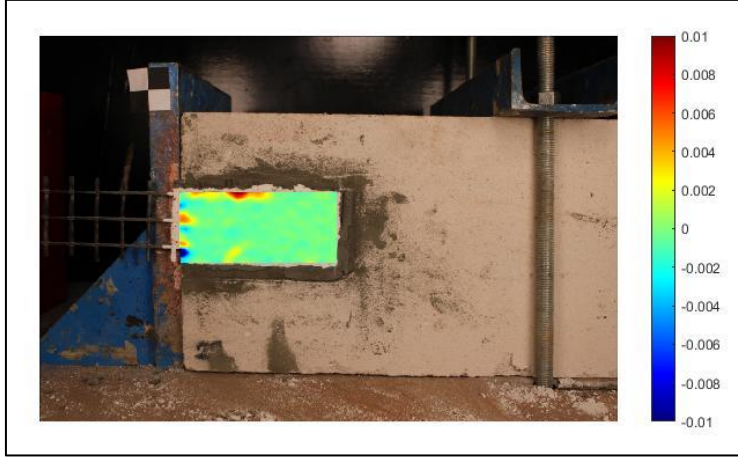
Şekil 3.83. #21 deney elemanına ait birim deformasyon dağılımı (y-y doğrultusu)
