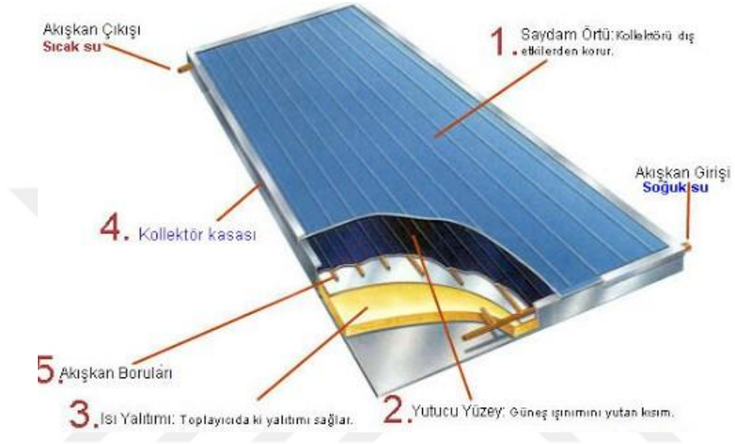
Şekil 4.1. Düzlemsel Güneş Kolektörünün Yapısı [35]
