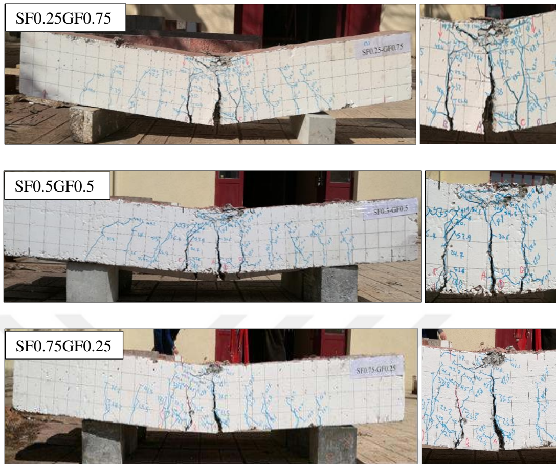
(d) Crack pattern and failure mode for group C
