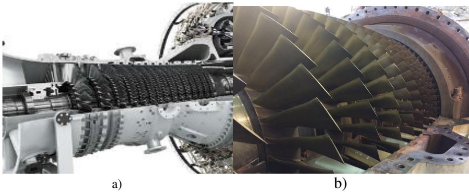
Şekil 4.3. Kompresör a) Siemens türbini b) Aen türbini.
