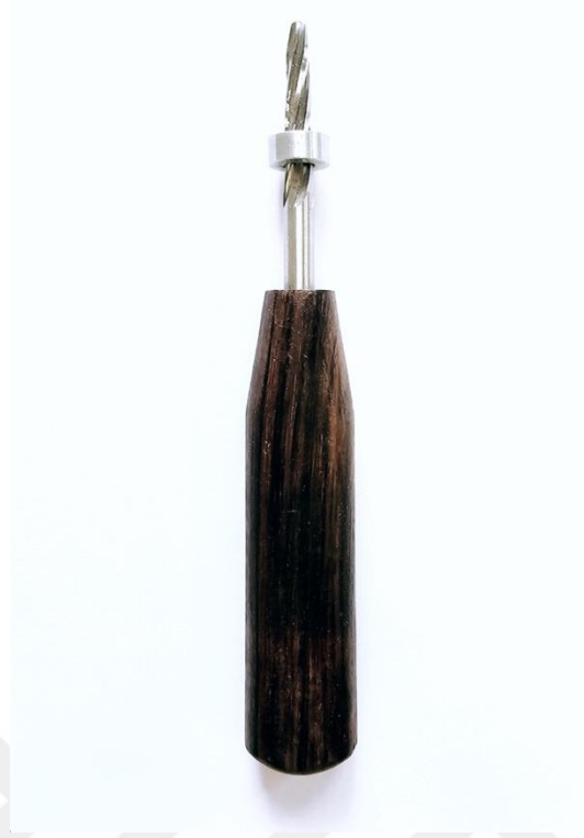
Görsel 2.9. Arka Açma Aleti ve Ölçülendirme Aparatı
