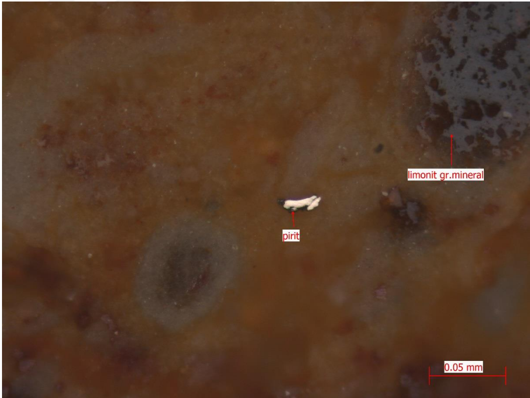
Şekil 4.35. Fakılar boksit cevherlerinin optik mikroskopisi: FB-5 kodlu örnekte yaygın olarak demir hidroksit boyama arasında yuvarlak ve elipoidal şeklinde oolitler görülmektedir. Demir boyamalar içinde limonit mineral grubu ve eser miktarda görülen yarı öz şekilsiz tane halinde pirit yer almaktadır
