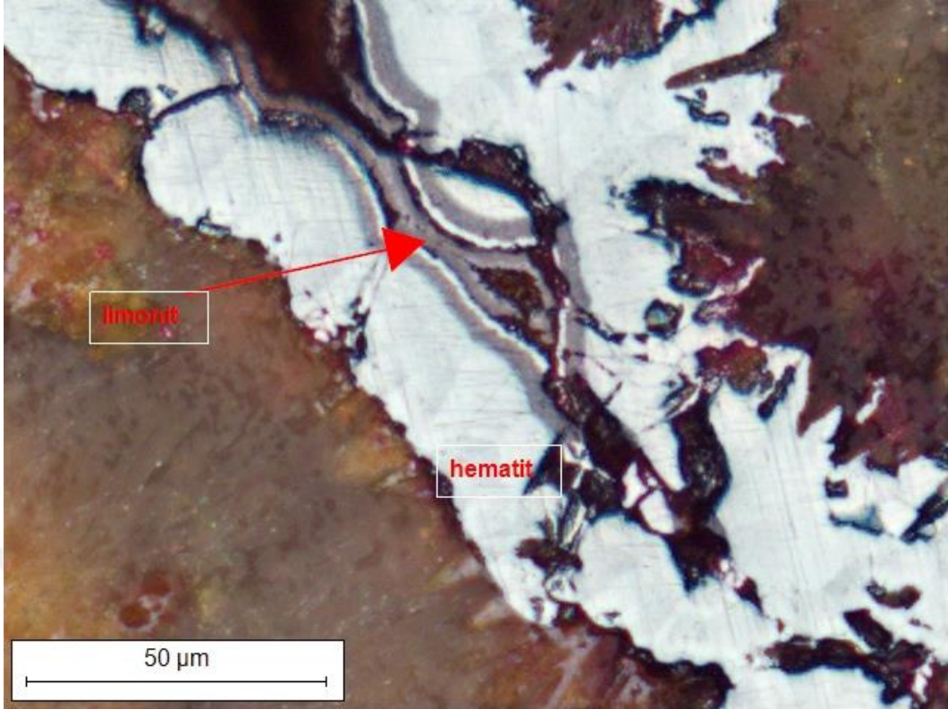
Şekil 4.43. Fakılar boksit cevherlerinin optik mikroskopisi: FB-6 kodlu örnekte izlenen kılcal çatlaklar hematit ve limonit minerali dolgulu olarak izlenmektedir
