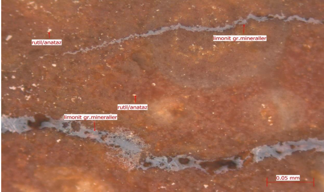
Şekil 4.14. Fakılar boksit cevherlerinin parlak kesit cevher mikroskopisi: FB-3 kodlu örnekte az sayıda mikro damar ve bu damalar içerisinde ilmenit mineral grubu, etrafında ise ince tane boylarında rutil/anatas ve demir boyamalı amorf toprakimsı material görülmektedir
