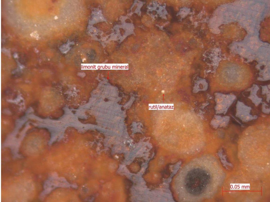
Şekil 4.29. Fakılar boksit cevherlerinin optik mikroskopisi: FB-5 kodlu örnekte demir hidroksit boyaması görülmektedir. Demir boyamalar içinde ve aralarında mikro tane boyunda rutil/anatas ve gri çizgi şeklinde görülen limonit grubu mineralleri etraflarında bağlayıcı olarak yer almaktadırlar
