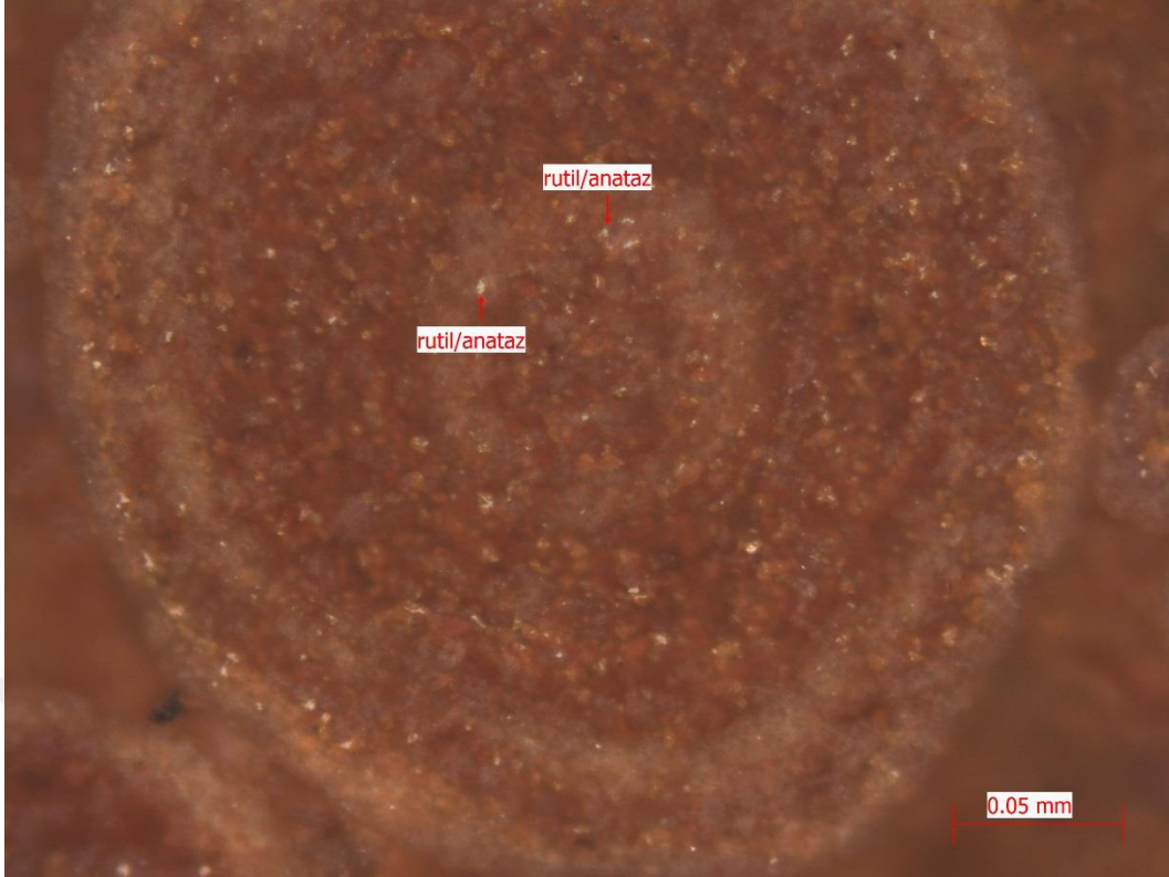
Şekil 4.20. Fakılar boksit örneğinin parlak kesit cevher mikroskopisi: FB-3 kodlu örnekte oolitlerin içerisinde yaygın bir şekilde gözlenen ince taneli rutil/anatas kristal parçaları
