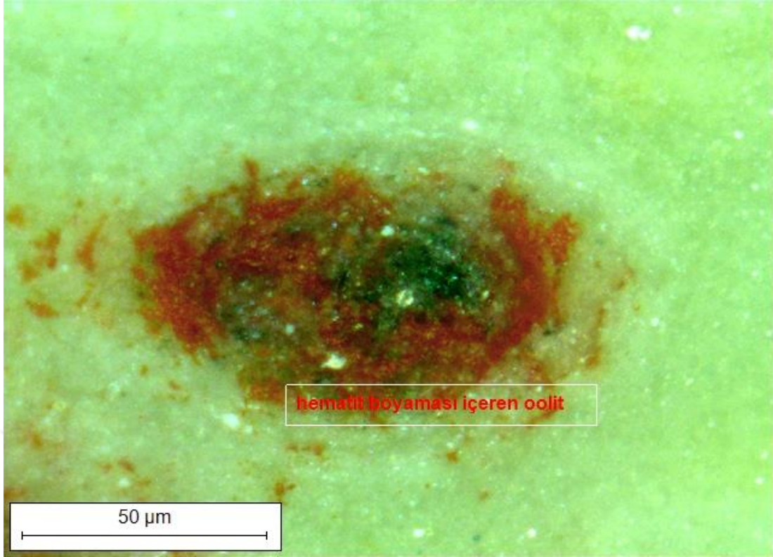
Şekil 4.45. Fakılar boksit cevherlerinin optik mikroskopisi: FB-6 kodlu örnekte izlenen hematit boyaması içeren elipsoidal şeklinde oolit mineralleri izlenmiştir
