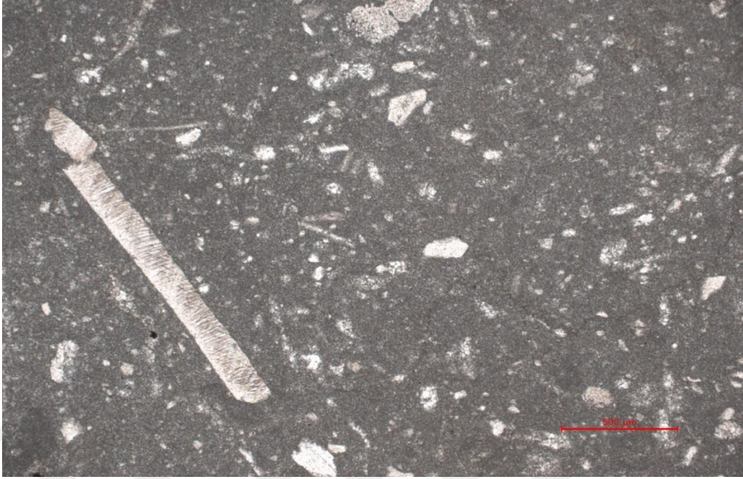
Şekil 4.9. FBA-4 kodlu boksit cevherlerinin ana kayacını temsil eden örneğinin ince kesit mikroskop görünümü: sparitik bağlayıcı içerisinde karbonat taneleri (kalsit) ve fosil kavkıları bulunmaktadır. Yer yer mikritik bağlayıcı da izlenmiştir. Fosil kavkıları karbonat dolguludur. Kalsit mineralleri ise küçük taneli olarak izlenmiştir. Fosil oranı ve bağlayıcısı dikkate alınarak örnek biosparit (fosilli kireçtaşı) olarak adlandırılmıştır, (Tek Nikol)
