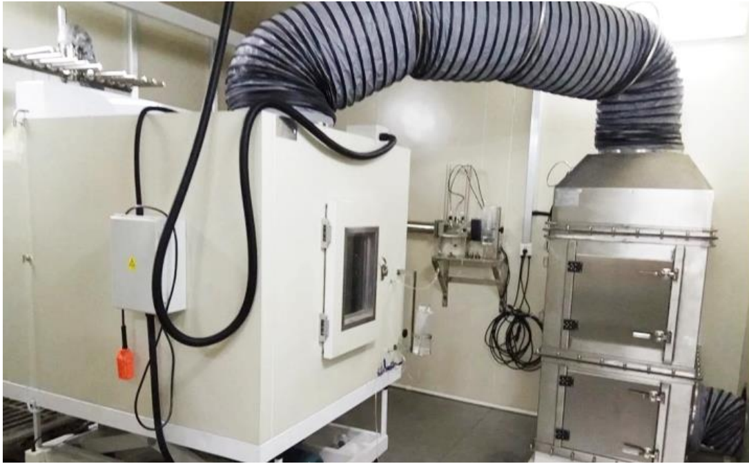
Şekil 3.1. Hava entalpi odası örnek görseli (Deltastark, 2024).
