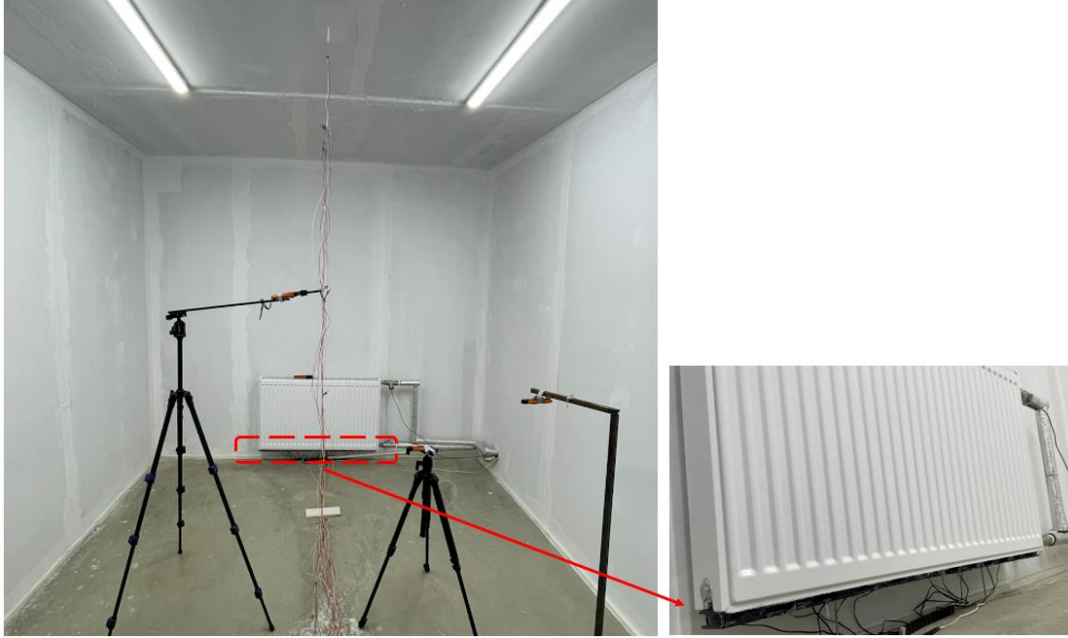
Resim 3.1. Deneylerin gerçekleştirildiği test odası ve fanlı panel radyatör
