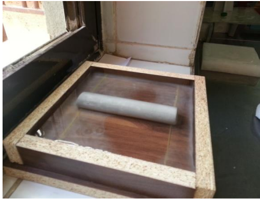
Şekil 10: Erişmiş parafin ve merkezde Ti6Al4V protez örneği.
