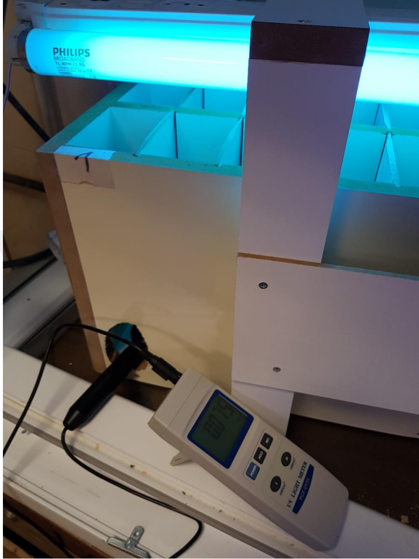
Resim 8: UVB uygulaması sırasında lambadan yayılan ışın dozunun hesaplanması
