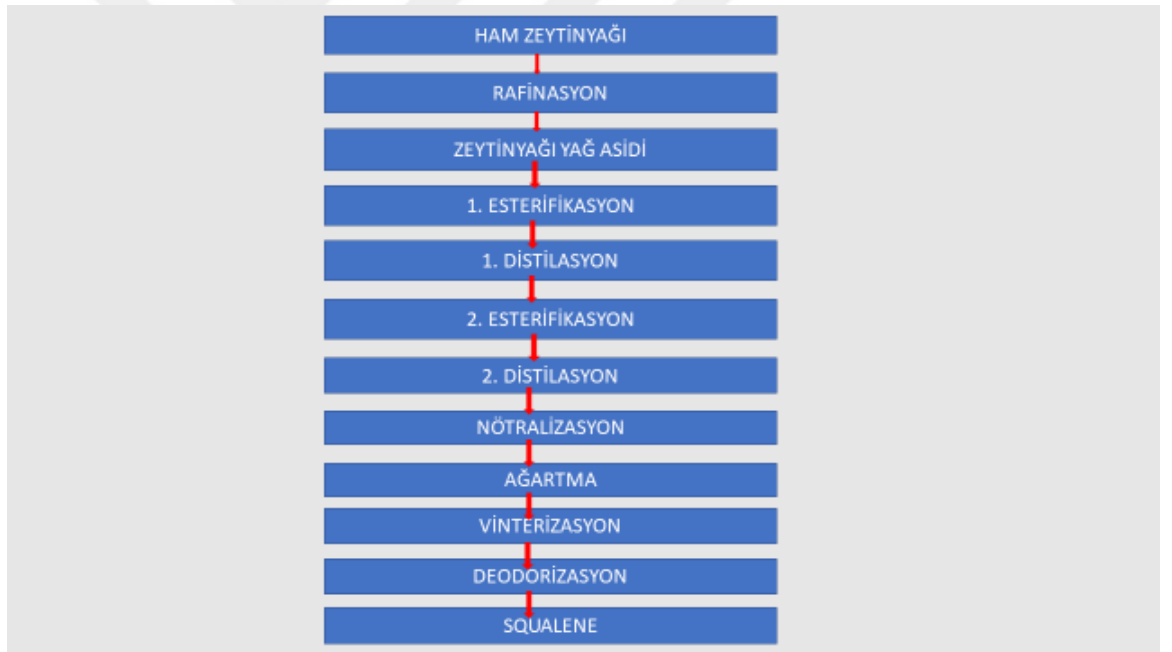
Şekil 11: Ham zeytinyağından skualenin elde edilme süreci
