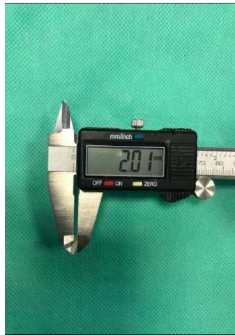
Şekil 3.3. Numune boyutlarının dijital kumpasla ölçümü
