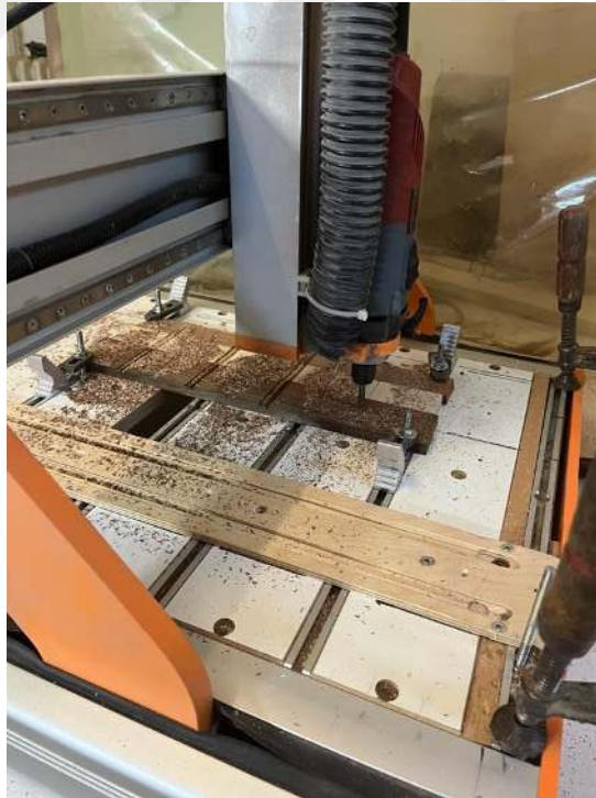
Şekil 3.1. Çalışmada kullanılacak köprülerin CNC makinesinde hazırlanması
