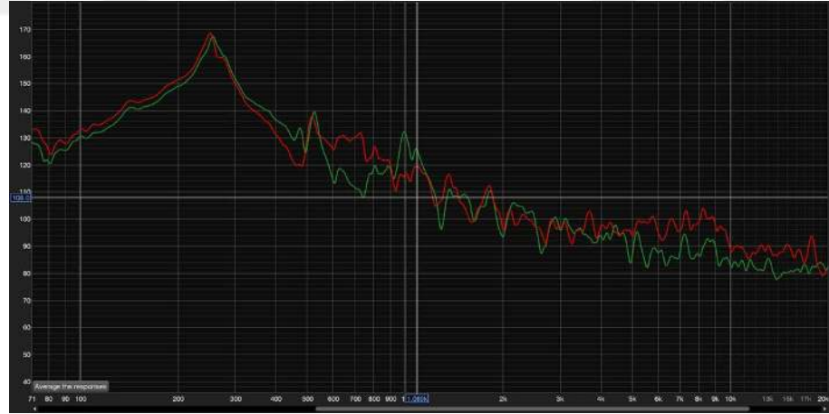
Şekil 4.35. Ses tahtası ile ardıc ağacından yapılan köprünün kayıtları
