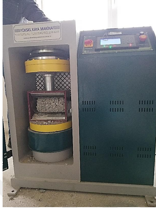
Resim 3.20 Yarmada-çekme dayanımı deneyi yapılışı
