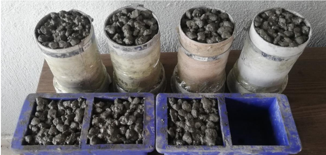
Resim 3.8 Taze betonun kalıplanması
