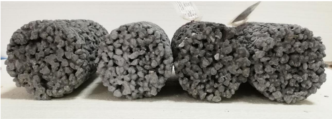
Resim 3.12 4-11,2 mm kırmataş agregalar ile üretilen betonların dip görüntüsü
