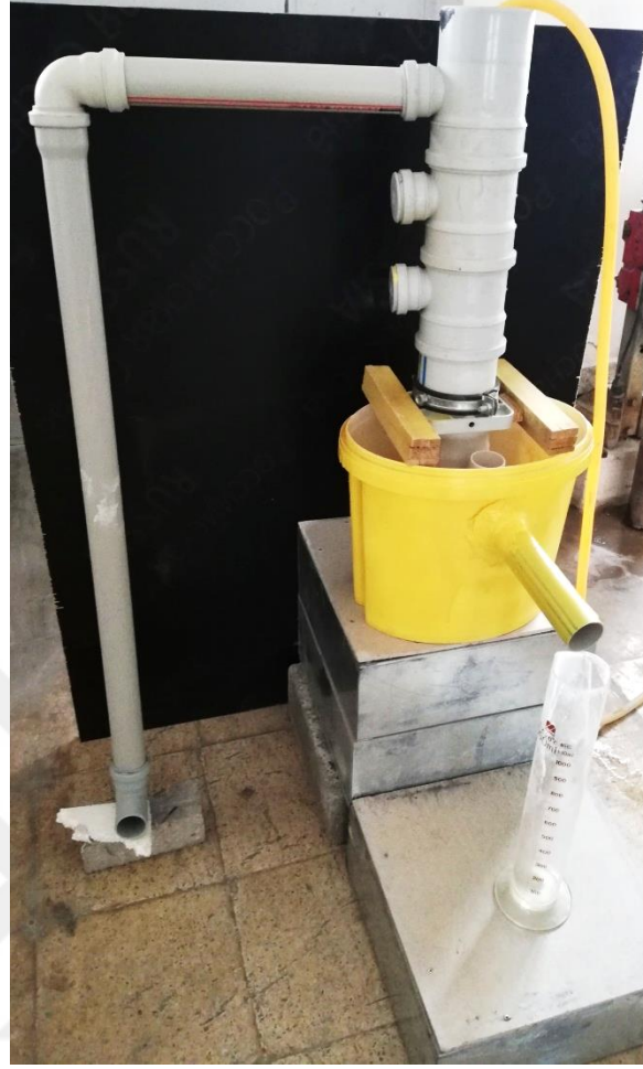
Resim 3.17 Sabit seviyeli geçirimsizlik deney düzeneği
