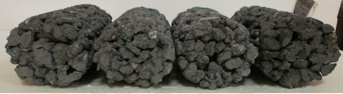
Resim 3.14 11,2-22,4 mm doğal agrega ile üretilen betonların dip görüntüsü
