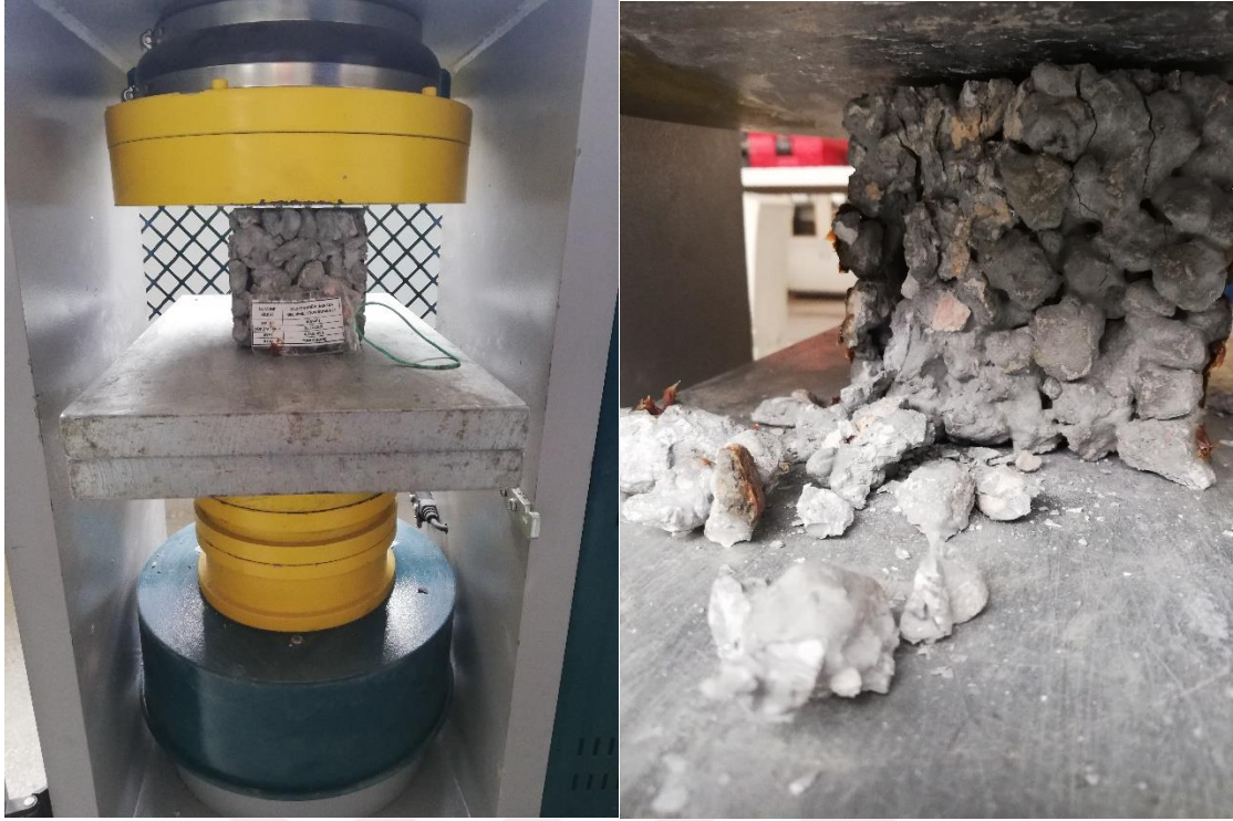
Resim 3.19 Basınç dayanımı deneyi ve 11,2-22,4 mm doğal agregalı numunenin kırılma görseli
