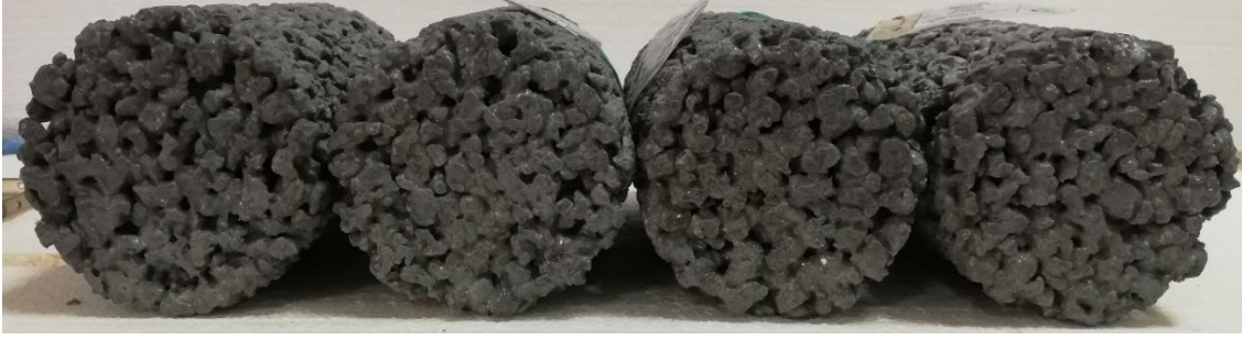
Resim 3.13 4-11,2 mm beton kırığı agrega ile üretilen betonların dip görüntüsü
