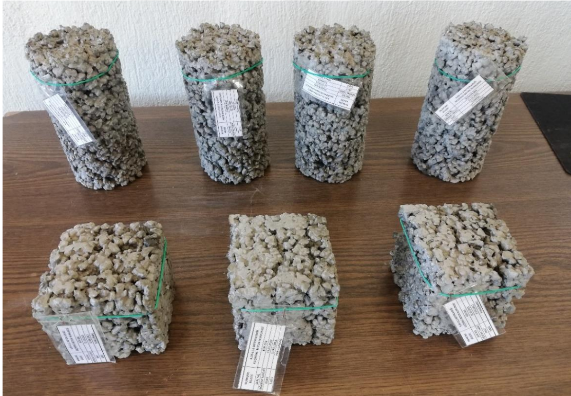
Resim 3.10 4-11,2 mm beton kırığı agregalı numunelerinin kalıptan çıkarıldıktan sonraki durumu
