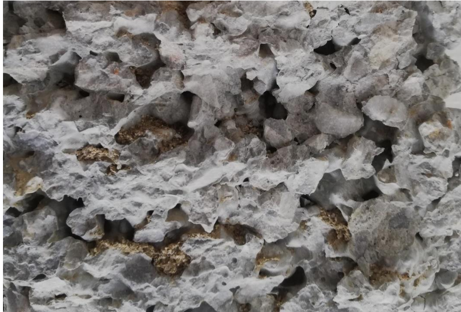
Resim 4.4 4,00-11,2 mm beton kırığı numunenin iç boşluklarında sediment birikimi
