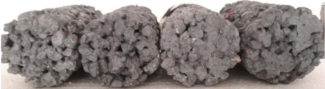
Resim 3.16 11,2-22,4 mm beton kırığı agrega ile üretilen betonların dip görüntüsü
