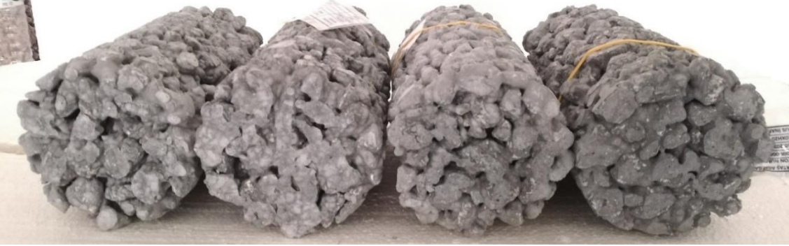
Resim 3.15 11,2-22,4 mm kırmataş agrega ile üretilen betonların dip görüntüsü
