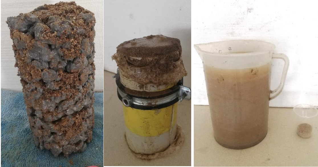
Resim 3.23 Geçirimli betonun bir tıkanma döngüsünde kullanılan kum ve suda çözünmüş kil, tıkanma sonrası geçirimli betonun görünüşü.
