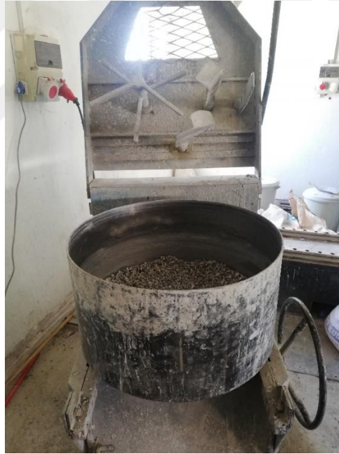
Resim 3.5 Beton karışımında kullanılan mikser.
