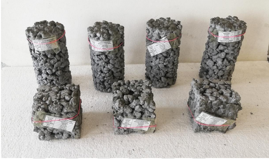
Resim 3.9 11,2-22,4 mm beton kırığı agregalı numunenin kalıptan çıkarıldıktan sonraki durumu
