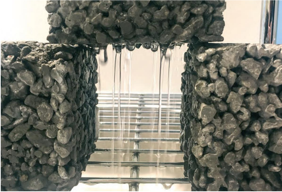
Resim 2.1 Geçirimli beton (Çevre ve Şehircilik Bakanlığı 2018).
