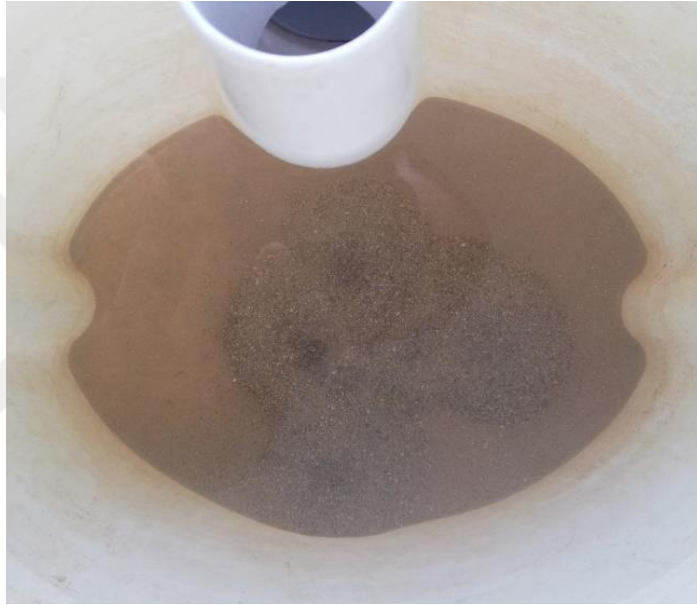
Resim 4.5 Kum ve kil partiköllerinin deney düzeneęinde ökeltmesi
