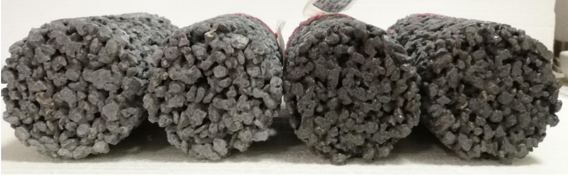
Resim 3.11 4-11,2 mm doğal agregalar ile üretilen betonların dip görüntüsü
