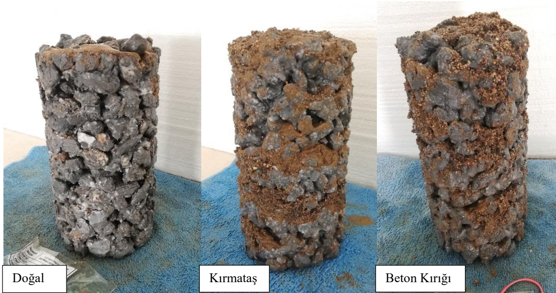
Resim 4.2 11,2-22,4 mm agregalı numunelerin tıkanma sonrası durumu
