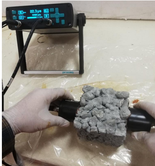
Resim 3.22 Ultrases geçiş hızı deneyi yapılışı
