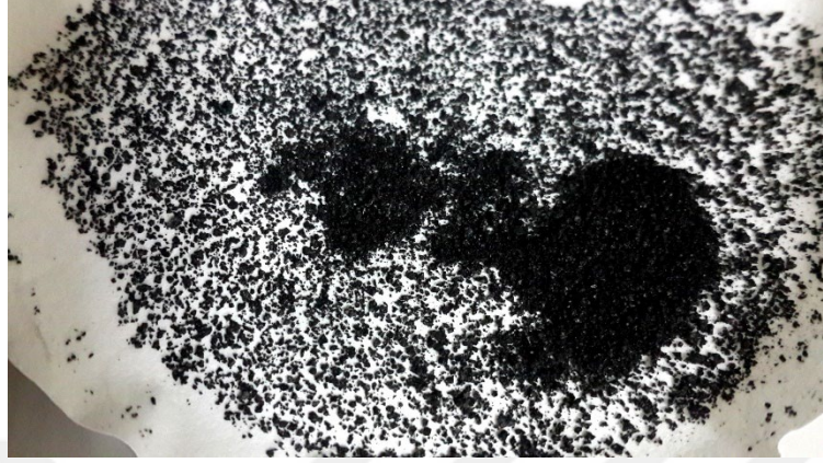
Şekil 12. Karbon köpüklerin H_3PO_4 ile aktivasyon sonucu elde edilen aktif karbon örneği
