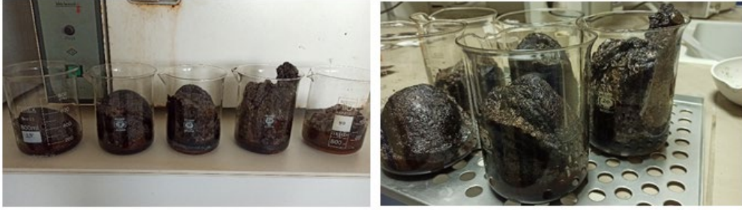
Şekil 10. Farklı konsantrasyonlarda \text{Co}(\text{NO}_3)_2 ile hazırlanan karbon köpük numuneleri
