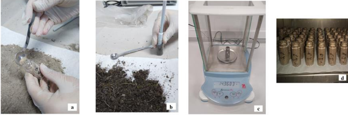
Şekil 5.9. a: Küvete toprağın konulması, b: toprağın küvette boşluk kalmayacak şekilde sıkıştırılması, c: örneğin hassas terazi ile tartım işlemi, d: örneklerin etüve (Nüve Dry Air Sterilizer FN 005) yerleştirilmesi
