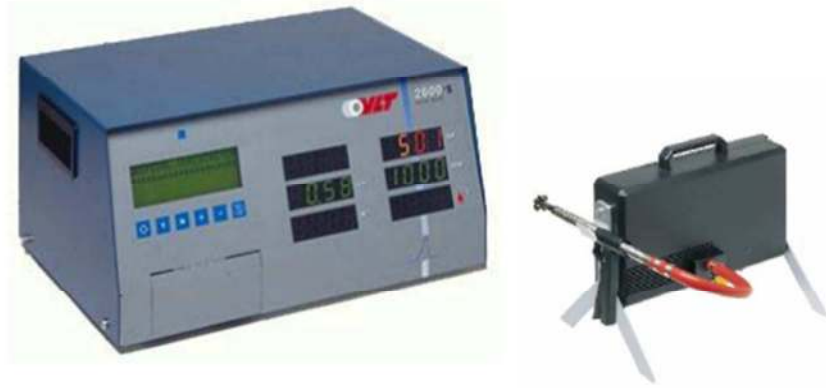
Resim 4.2. VLT 2600 S Opasimetre
