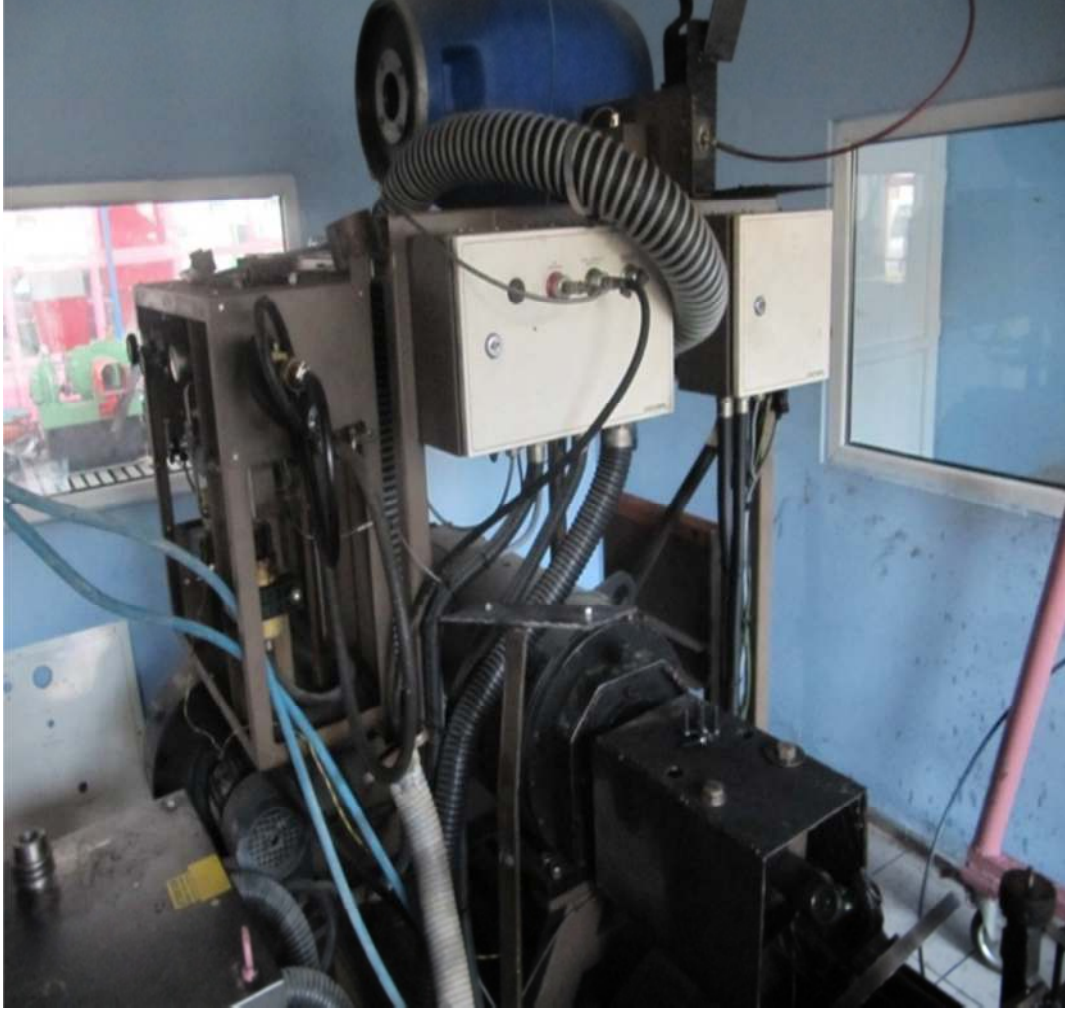
Resim 4.1. Cussons P8653 D.C. Rejenaratif Dinamometre
