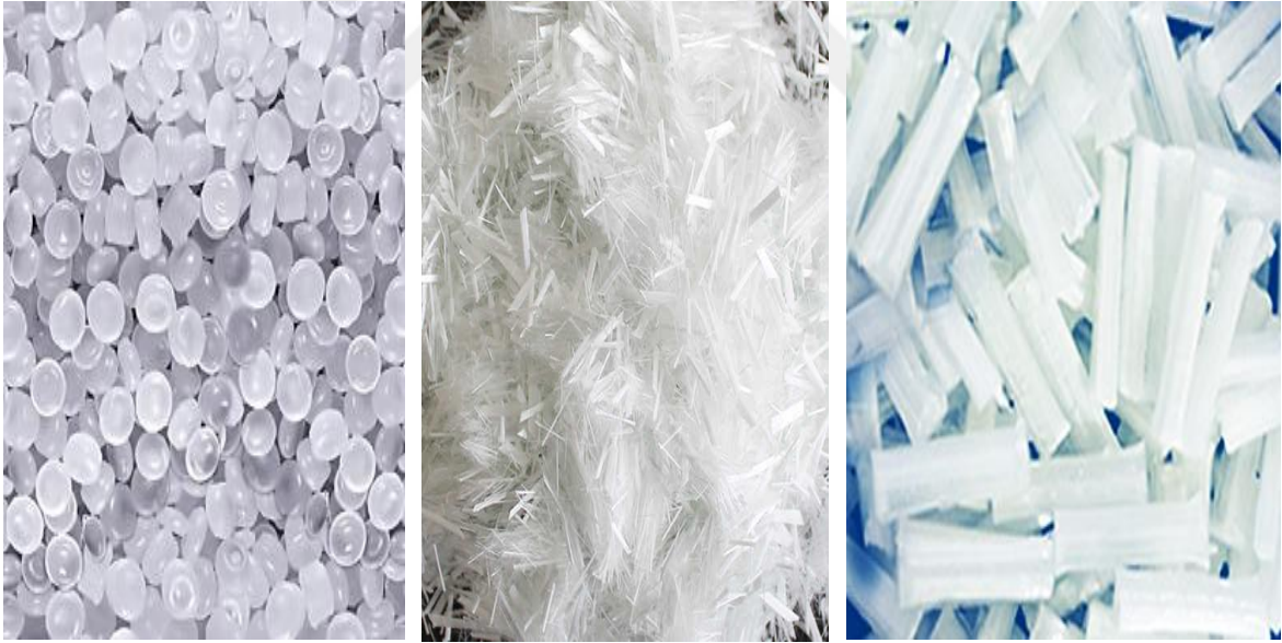
Şekil 2. 10. Ekstrüzyon işlemi ile üretilen cam fiber takviyeli kompozitin oluşumu
