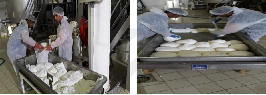
Resim 3.1 Telemenin süzeklere alınması ve süzeklerin döndürülüp ters konması.
