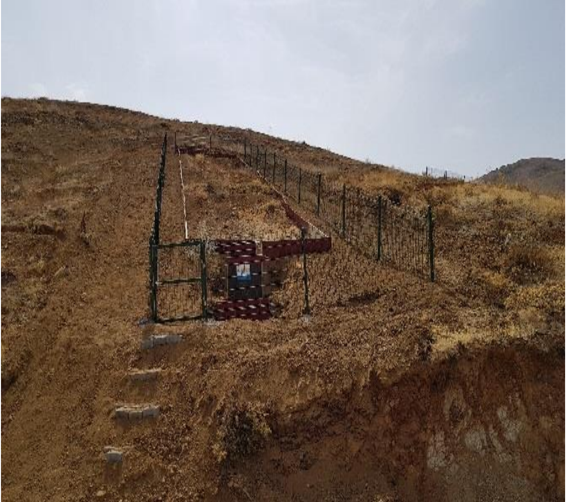
Şekil 2.11: Hamzabey mikrohavzasın TM sahası üzerine kurulan TM_T yüzeysel akış parselinden bir görünüm (Fotoğraf: Mahmut Yılmaz 2018).
