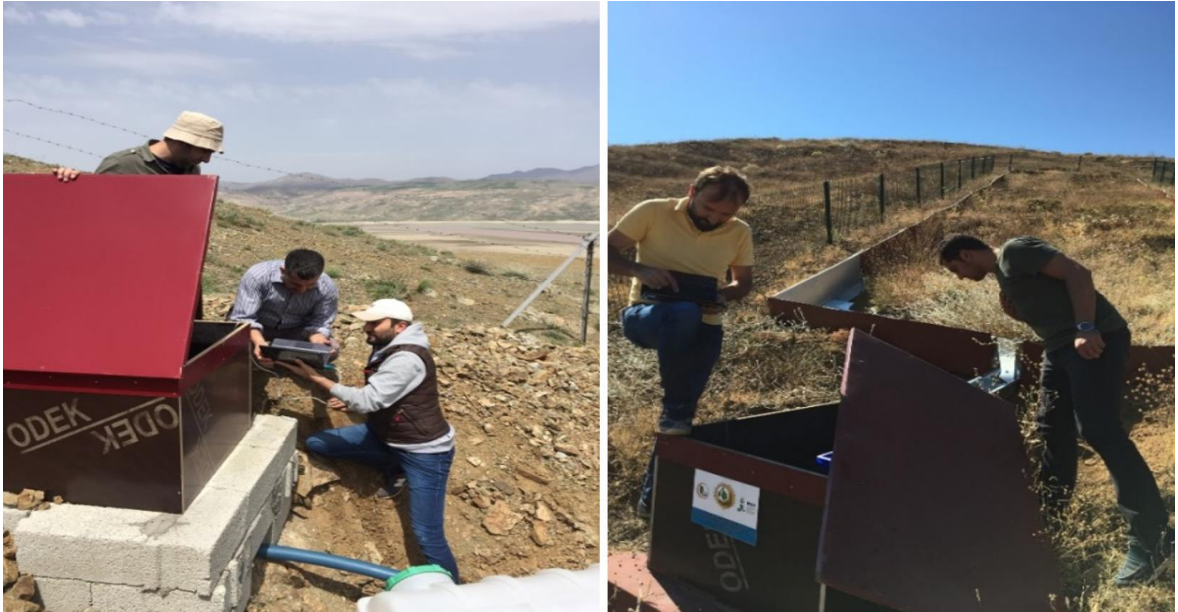
Şekil 2.13: Arazide yüzeysel akış parselleri ve yağış ölçerlerden bilgisayar ile veri alınması (ÇEM 2018).
